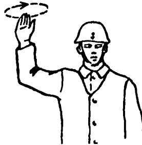
Рис. 2. Правая рука поднята вверх, полусогнута, плечо горизонтально, предплечье в вертикальном положении: "Поднять медленно" - кисть вращать по часовой стрелке; "Поднять быстро" - рукой до локтя вращать по часовой стрелке
