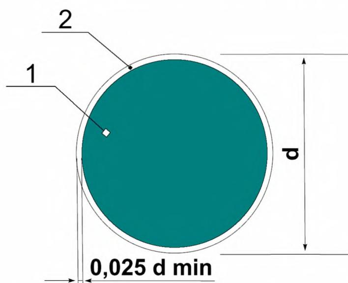
$d$  – диаметр круга; 1 – основная поверхность; 2 – кант
