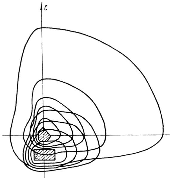
Рис.4. Наложение зон с различной СЗА от предприятия химической промышленности (1) и нефтехимического завода (2)
