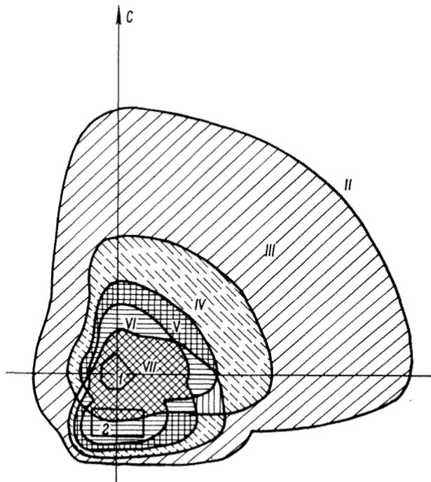
Рис.5. Пример определения СЗА в зонах наложения загрязнений от предприятия химической промышленности (1) и нефтехимического завода (2):
