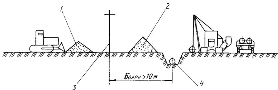
**Рис.2. Схема расположения при совмещенном строительстве трубопровода и вдольтрассовой ЛЭП 6-10 кВ;**
