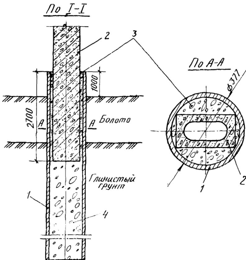
Рис.6. Закрепление промежуточных опор на болотах:
