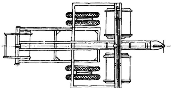
Рис.9. Одноосная трехбарабанная саморазгружающаяся раскаточная тележка грузоподъемностью 3 т; габариты: 4550x2790x2100
