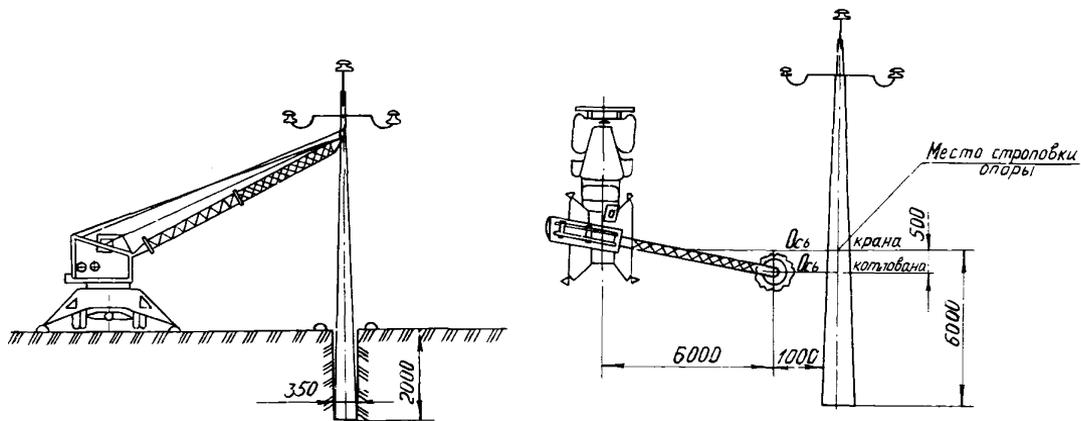
Рис.5. Установка однофазных опор ВЛ-6 -10 кВ с помощью автомобильного крана
