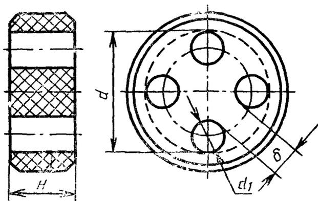
*d* — диаметр проходного отверстия в расточке кабельного ввода (см. черт. 12), *d*<sub>1</sub> — диаметр отверстия в уплотнительном кольце, *δ* — минимальное расстояние между отверстиями, *H* — высота уплотнительного кольца
