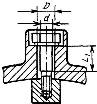
$W_d = D - d$  — ширина щели цилиндрического взрывонепроницаемого соединения;  $L_1$  — длина щели
