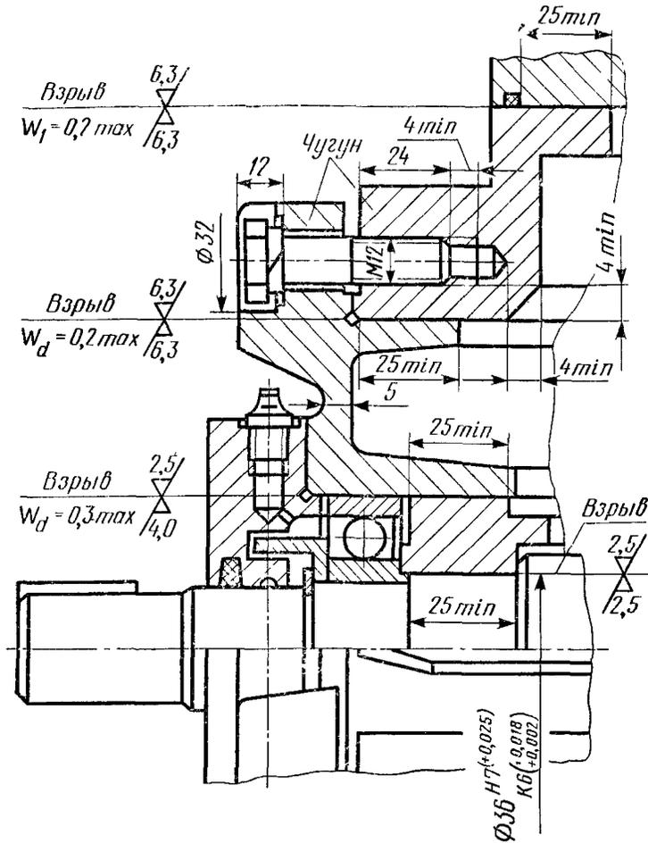
$W_1$  — ширина щели плоского взрывонепроницаемого соединения;  $W_d$  — ширина щели цилиндрического взрывонепроницаемого соединения
