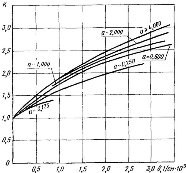
$a = \frac{V_2}{V_1}$  — кратность объемов отделения, в котором происходит разгрузка давления (объем  $V_2$ ) и смежного отделения (объем  $V_1$ )
