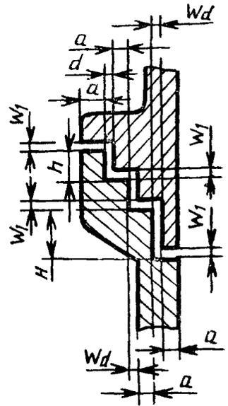
$W_1$  — ширина щели плоской части лабиринтного взрывонепроницаемого соединения;  $W_d$  — ширина щели цилиндрической части лабиринтного взрывонепроницаемого соединения;  $a$ ,  $h$ ,  $H$  — участки щели лабиринтного взрывонепроницаемого соединения
