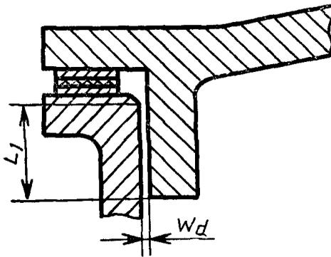
$W_d$  — ширина щели цилиндрического взрывонепроницаемого соединения;  $L_1$  — длина щели
