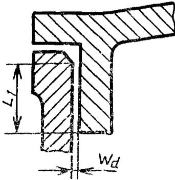
$W_d$  — ширина щели цилиндрического взрывонепроницаемого соединения;  $L_1$  — длина щели
