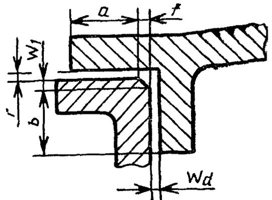
$W_1$  — ширина щели плоского взрывонепроницаемого соединения,  $W_1$  — ширина щели цилиндрического взрывонепроницаемого соединения,  $L_1 = a + b$  — длина щели,  $r$  — размер фаски
