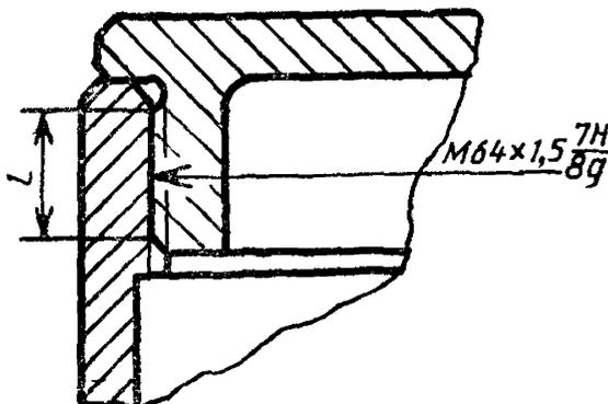
$l$  — осевая длина резьбового взрывонепроницаемого соединения
