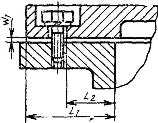
$W_1$  — ширина щели плоского взрывонепроницаемого соединения,  $L_1$  — длина щели,  $L_2$  — длина щели до отверстия
