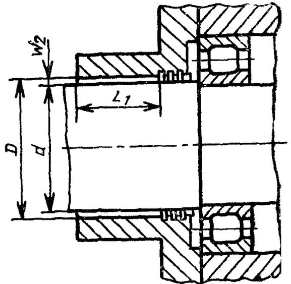
$W_2 = D - d$  — ширина щели цилиндрического взрывонепроницаемого соединения;  $W_2$  — ширина радиальной щели,  $L_1$  — длина щели
