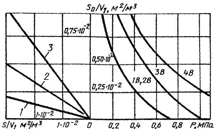
1 — для устройств с металлокерамическими огнепреградителями; 2 — для устройств с огнепреградителями с гранулированной набивкой и сеточными огнепреградителями; 3 — для устройств с щелевыми огнепреградителями;  $V_1$  — свободный объем оболочки, м<sup>3</sup>; S — суммарная площадь сечения каналов огнепреградителя, м<sup>2</sup>,  $S_0$  — суммарная площадь сечения каналов, приведенных к эквивалентному отверстию, м<sup>2</sup>
