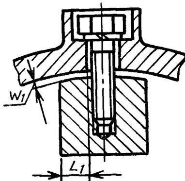
$W_1$  — ширина щели плоского взрывонепроницаемого соединения;  $L_1$  — длина щели
