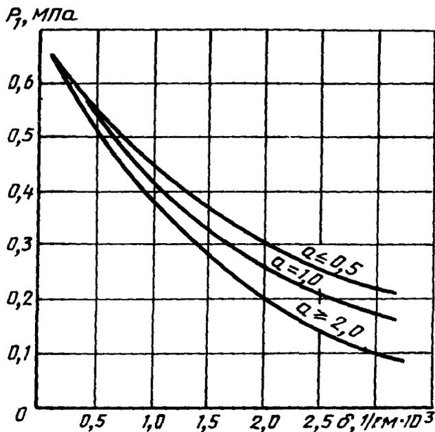
$a = \frac{V_2}{V_1}$  — кратность объемов отделения, в котором происходит разгрузка давления (объем  $V_2$ ) и смежного отделения (объем  $V_1$ )
