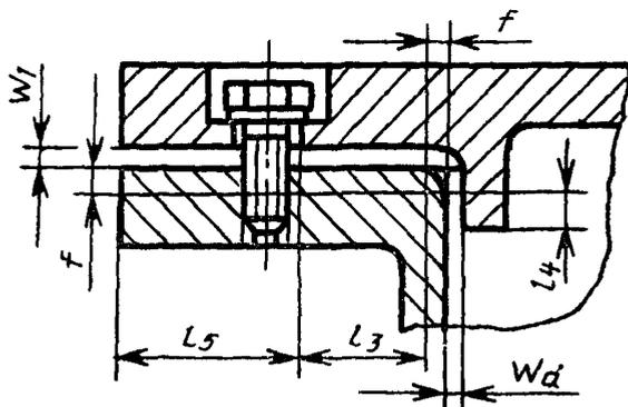
$W_1$  — ширина щели плоского взрывонепроницаемого соединения;  $W_d$  — ширина щели цилиндрического взрывонепроницаемого соединения;  $f$  — размер фаски;  $L_3$  — длина плоской части плоскоцилиндрического взрывонепроницаемого соединения;  $L_4$  — длина цилиндрической части плоскоцилиндрического взрывонепроницаемого соединения
