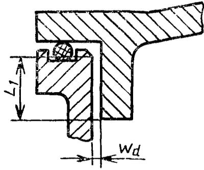
$W_d$  — ширина щели цилиндрического взрывонепроницаемого соединения,  $L_1$  — длина щели
