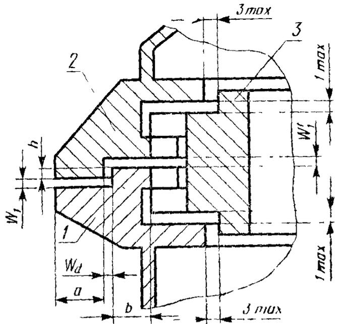
$W_1$ ,  $y$  — ширина щели плоской части лабиринтного взрывонепроницаемого соединения;  $W_d$  — ширина щели цилиндрической части лабиринтного взрывонепроницаемого соединения;  $a$ ,  $b$ ,  $c$ ,  $h$  — участки щели лабиринтного взрывонепроницаемого соединения
