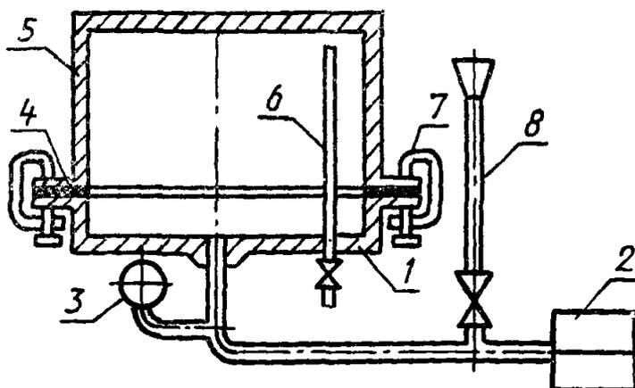
1 — стенд для гидроиспытаний; 2 — устройство для создания давления воды (насос); 3 — прибор для измерения давления; 4 — резиновая прокладка; 5 — испытываемая деталь; 6 — трубка для выхода воздуха при заполнении водой; 7 — струбцина для крепления испытываемой детали к стенду; 8 — трубка для предварительного заполнения оболочки водой
