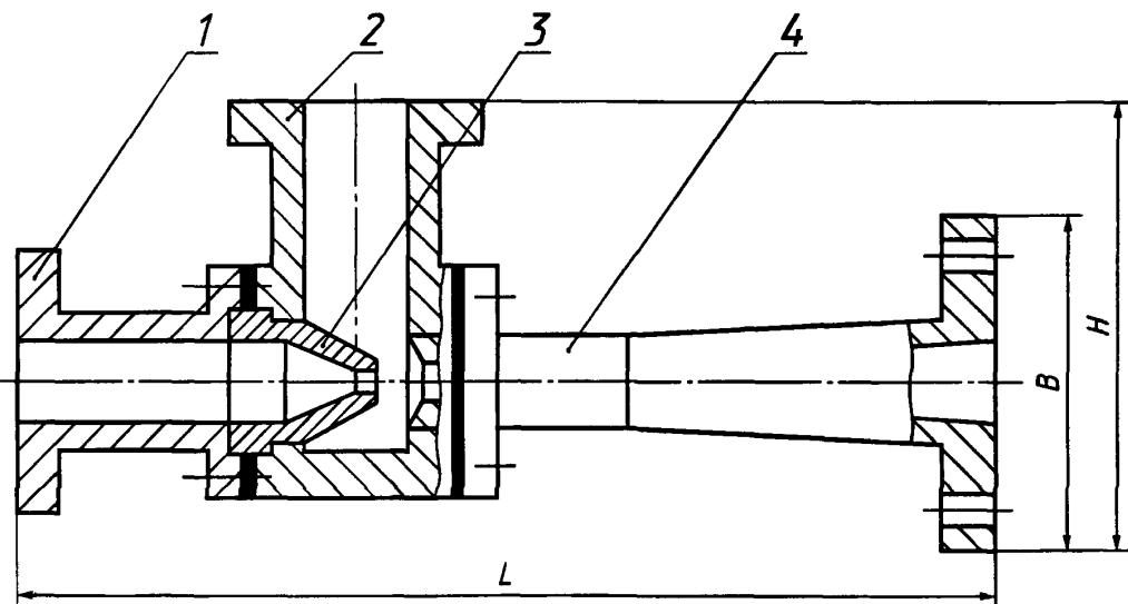
1 — входной патрубок; 2 — всасывающая камера; 3 — сопло; 4 — выходной патрубок
