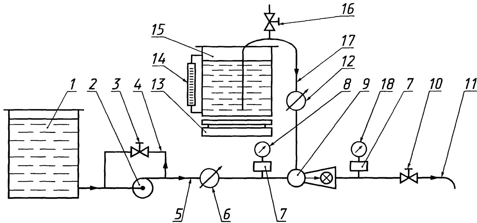
1 — емкость для воды; 2 — насос; 3 — вентиль; 4 — обводное кольцо на насосе; 5 — напорный трубопровод; 6, 12 — водомер;
