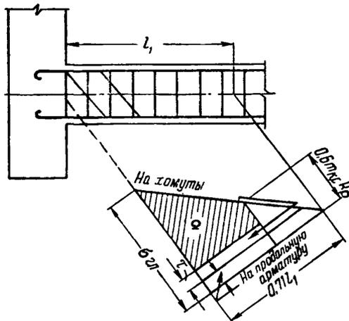
Рис. 4. Схема распределения усилий при расчете поперечной арматуры по эпюре главных растягивающих напряжений
