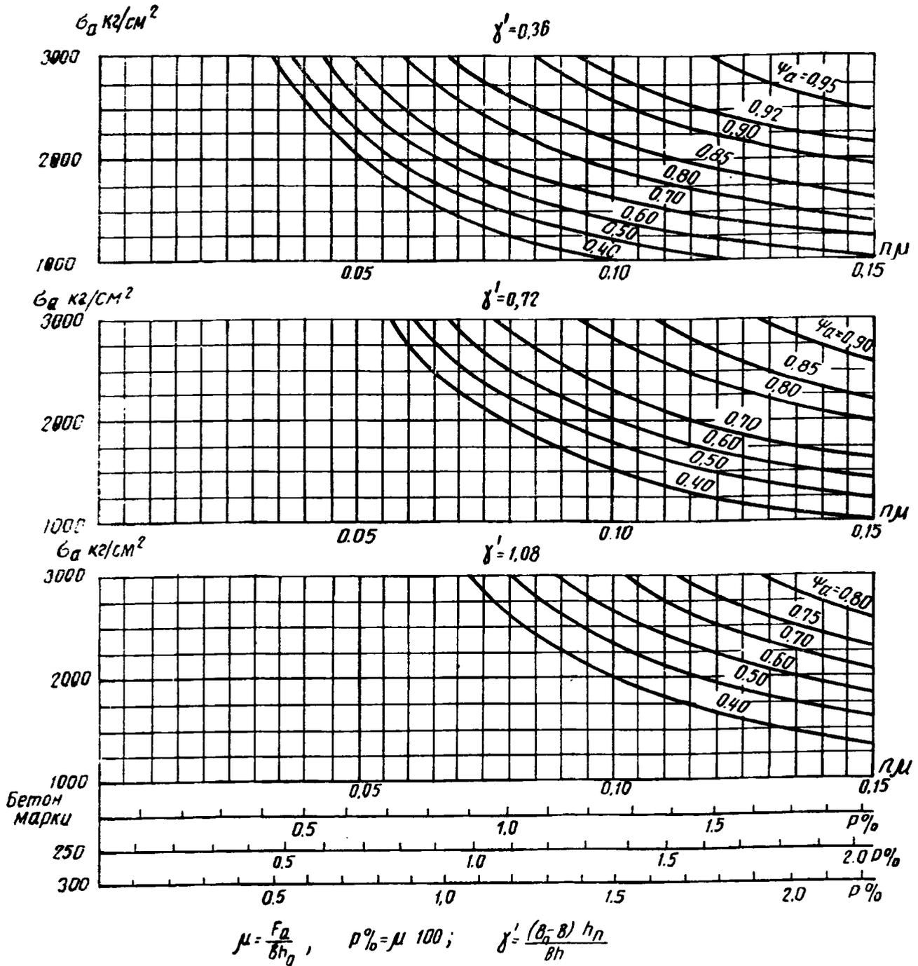
График 4. Изгибаемые элементы двутаврового и коробчатого сечений
