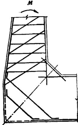
Рис. 6. Схема армирования угловых сопряжений массивных железобетонных конструкций
