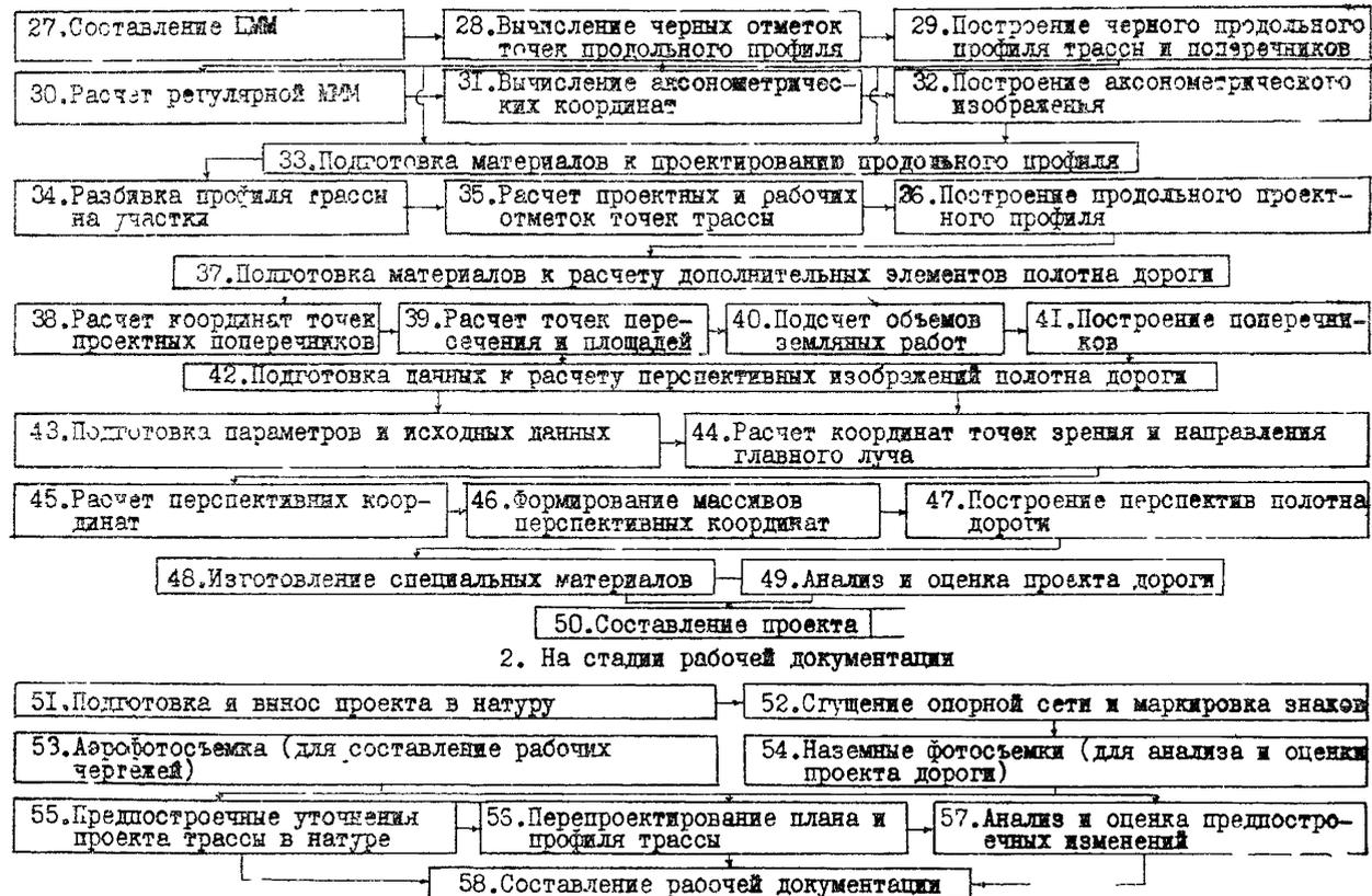
Рис. 17. Технологическая схема ландшафтного проектирования трассы автомобильной дороги с применением фотограмметрии, моделей местности и ЭВМ
