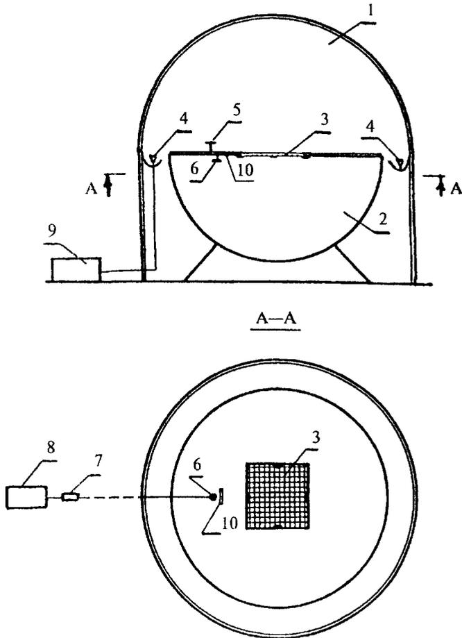
1 — источник диффузного света; 2 — светомерная камера; 3 — проем с опорной решеткой; 4 — осветительные приборы источника света; 5 — наружный фотоэлемент; 6 — внутренний фотоэлемент; 7 — переключатель фотоэлементов; 8 — микроамперметр или гальванометр; 9 — регулятор напряжения осветительных приборов; 10 — экран фотоэлемента от прямого света источника
