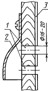
1 — вентиляционные отверстия; 2 — металлический козырек; 3 — водонепроницаемый материал
