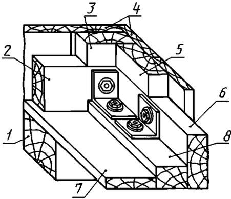
1 — полз; 2 — продольный брус бокового щита; 3 — стойка угловая бокового щита; 4 — доска обшивки; 5 — стойка угловая; 6 — продольный брус торцового щита; 7 — доска дна; 8 — торцовый брус
