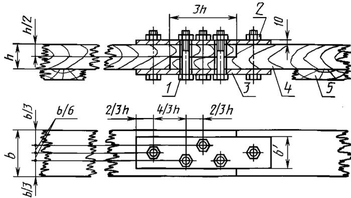
1 — болт (5 шт.); 2 — гайка (5 шт.); 3 — пластина, Ст. 3 по ГОСТ 380 (2 шт.); 4 — брус (2 шт.); 5 — доска подполозная;  $d$  — диаметр болта;  $h$  — толщина полоза;  $b$  — ширина полоза;  $b'$  — ширина накладки
