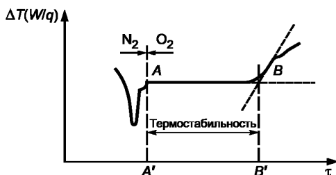
Рисунок 1 — Типичная кривая окислительной термостабильности полиэтилена
