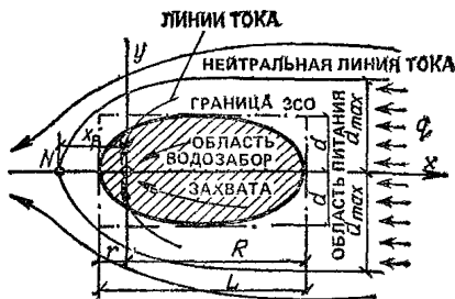
Рис. 62. Схема фильтрации подземных вод к водозабору
