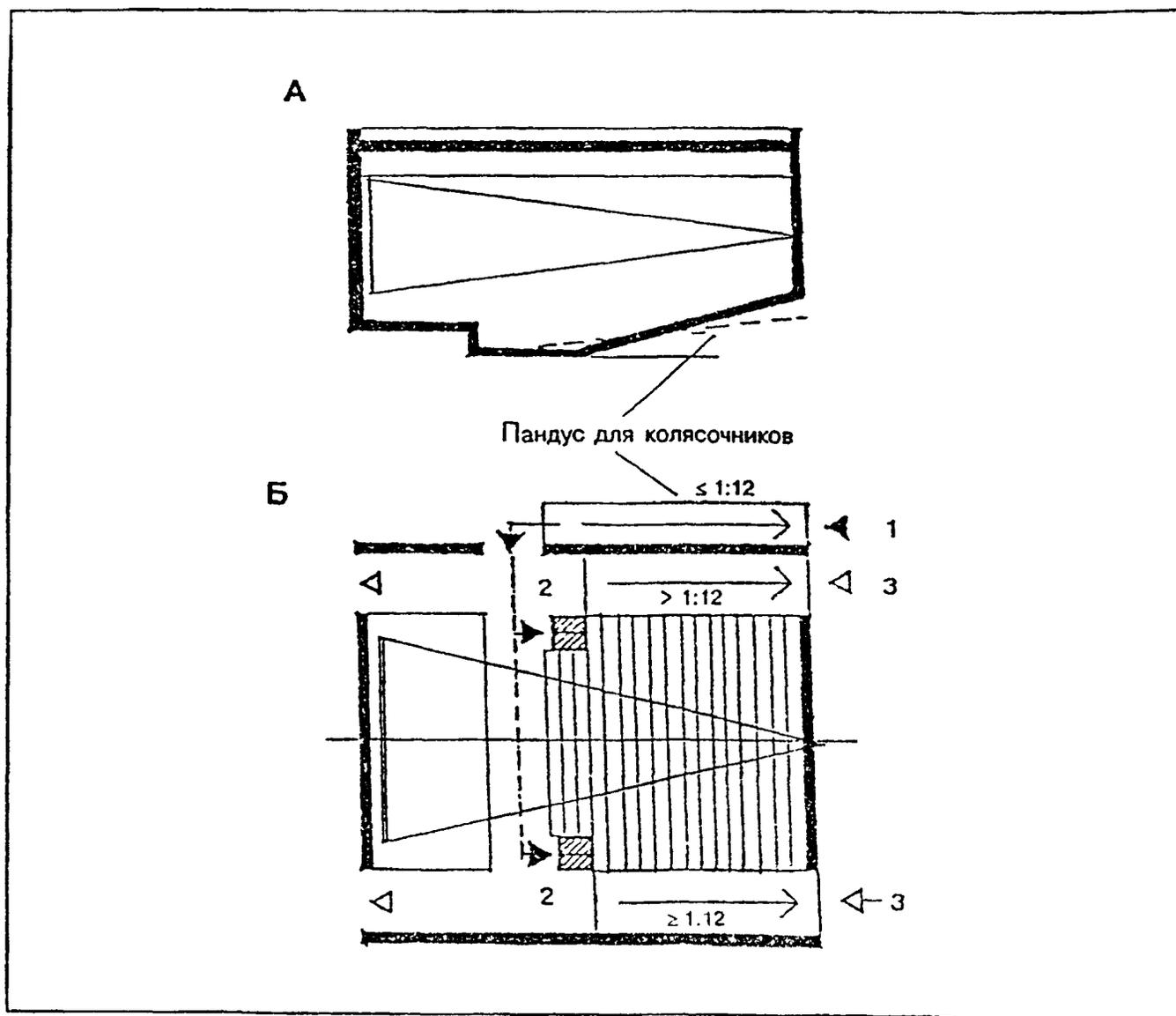
Пример решения загрузки и эвакуации инвалидов-колясочников из кинозала с уклоном пандуса более 1:12
