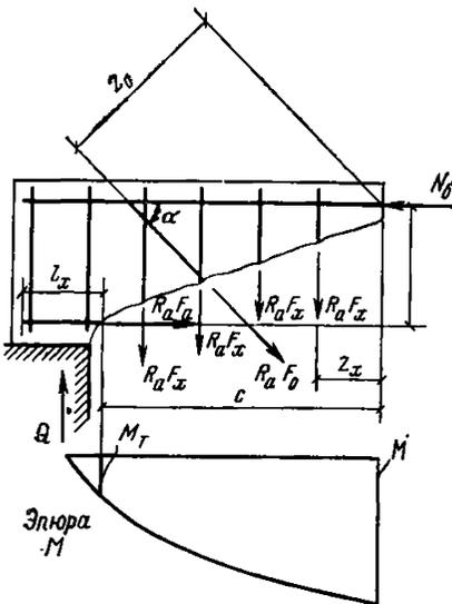
Рис. 17. Схема усилий, действующих в наклонном сечении, при расчете по изгибающему моменту  $N_0$  — равнодействующая усилий в сжатой зоне
