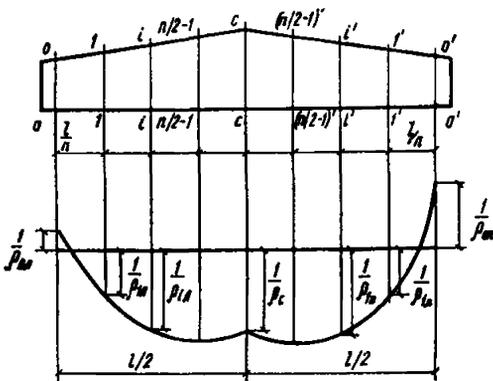
Рис. 84. Эпюра кривизны в железобетонном элементе с переменным по длине сечением
