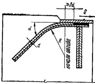
Рис. 127. Приварка отогнутого касательного анкера ручной электродуговой сваркой
