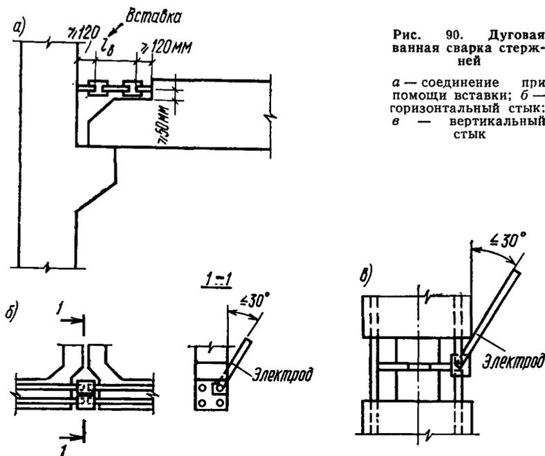
Рис. 90. Дуговая ванная сварка стержней
