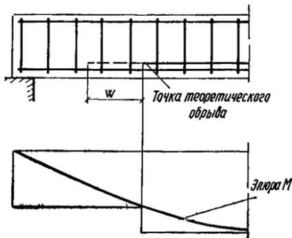
Рис. 20. Обрыв растянутых стержней в пролете
