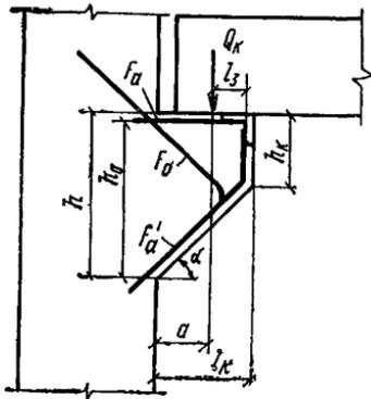
Рис. 64. Расчетная схема для короткой консоли при расчете ее по прочности на действие поперечной силы
