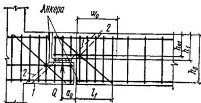
Рис. 21. Невыгоднейшие наклонные сечения в элементе с подрезкой
