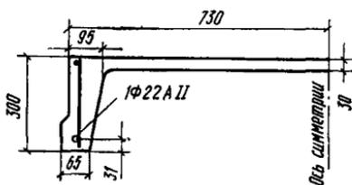
Рис. 86. Сборная железобетонная плита покрытия
