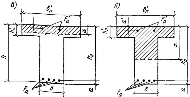
Рис. 5. Форма сжатой зоны в поперечном сечении таврового железобетонного элемента
