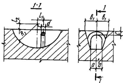
Рис. 124. Рекомендуемые размеры лунок для потайного расположения проушин строповочных петель
