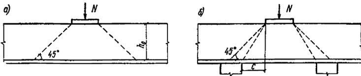
Рис. 58. Схема пирамиды продавливания при угле наклона ее боковых граней к горизонтали
