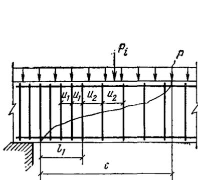
Рис. 19. Изменение интенсивности хомутов в пределах длины проекции наклонного сечения  $c$
