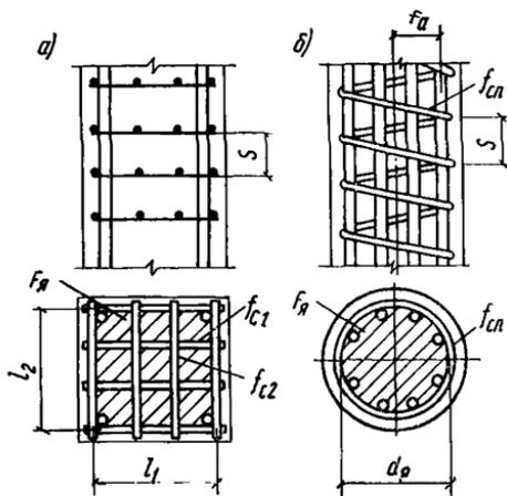
Рис. 27. Сжатые элементы с косвенным армированием в виде
