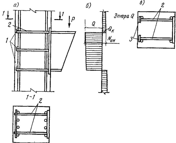
Рис. 72. Схема, принимаемая при расчете на откалывание бетона анкерами закладной детали
