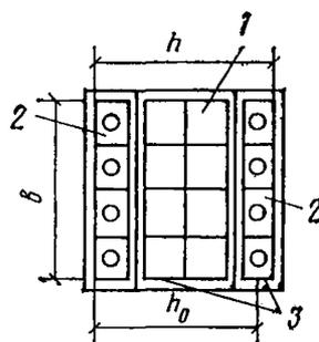
Рис. 75. Незамоноличенный стык колонны
