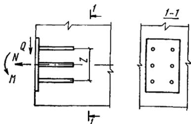
Рис. 67. Схема усилий, действующих на закладную деталь
