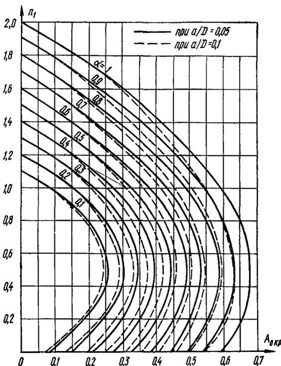
Рис. 35. Графики несущей способности внецентренно-сжатых элементов круглого сечения
