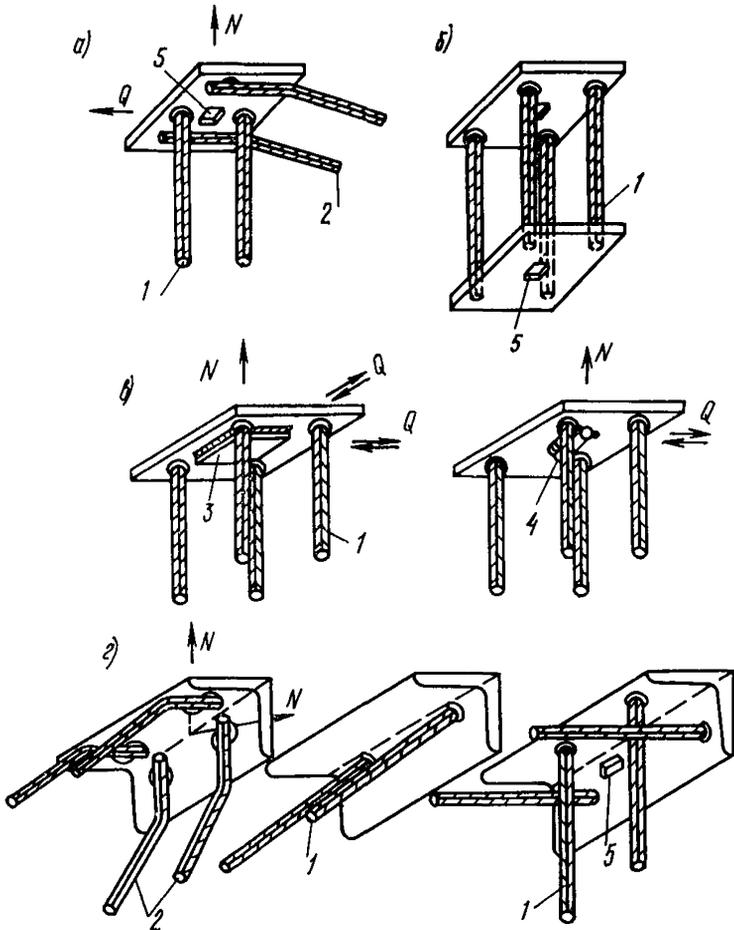
**Рис. 125.** Примеры конструкций закладных деталей
