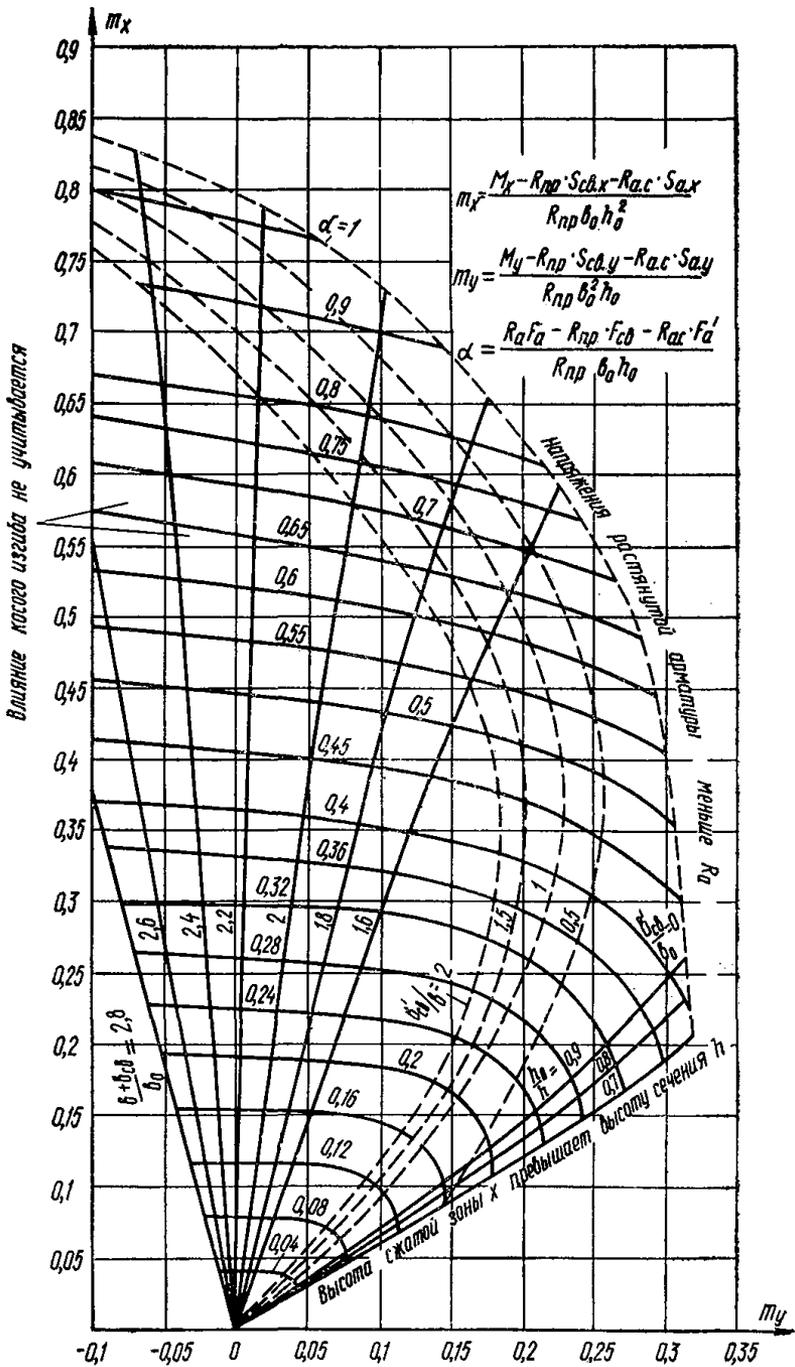
Рис. 9. График несущей способности прямоугольного, таврового и Г-образного сечения для элементов, работающих на косоуго изгиб
