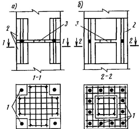
Рис. 121. Жесткий стык сборных колонн с ванной сваркой арматурных выпусков
