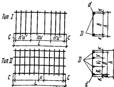
Параметры арматурных сеток, изготавливаемых на однотоочечных сварочных машинах
