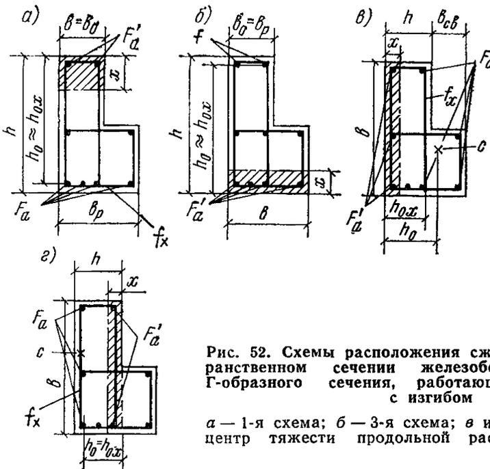
Рис. 52. Схемы расположения сжатой зоны в пространственном сечении железобетонного элемента Г-образного сечения, работающего на кручение с изгибом
