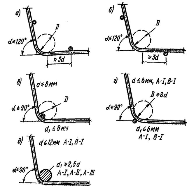
Рис. 94. Параметры гнутых сварных сеток
