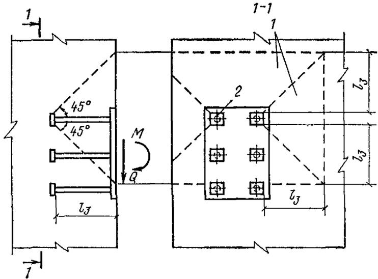
Рис. 71. Конструкция закладной детали, при которой не требуется расчет на выкалывание
