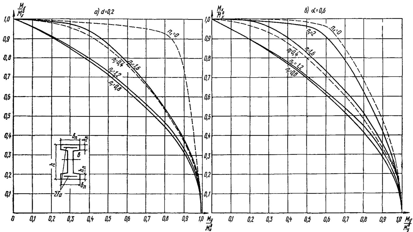
Рис. 38. Графики несущей способности элементов симметричного двутаврового сечения, работающих на косо внецентренное сжатие
