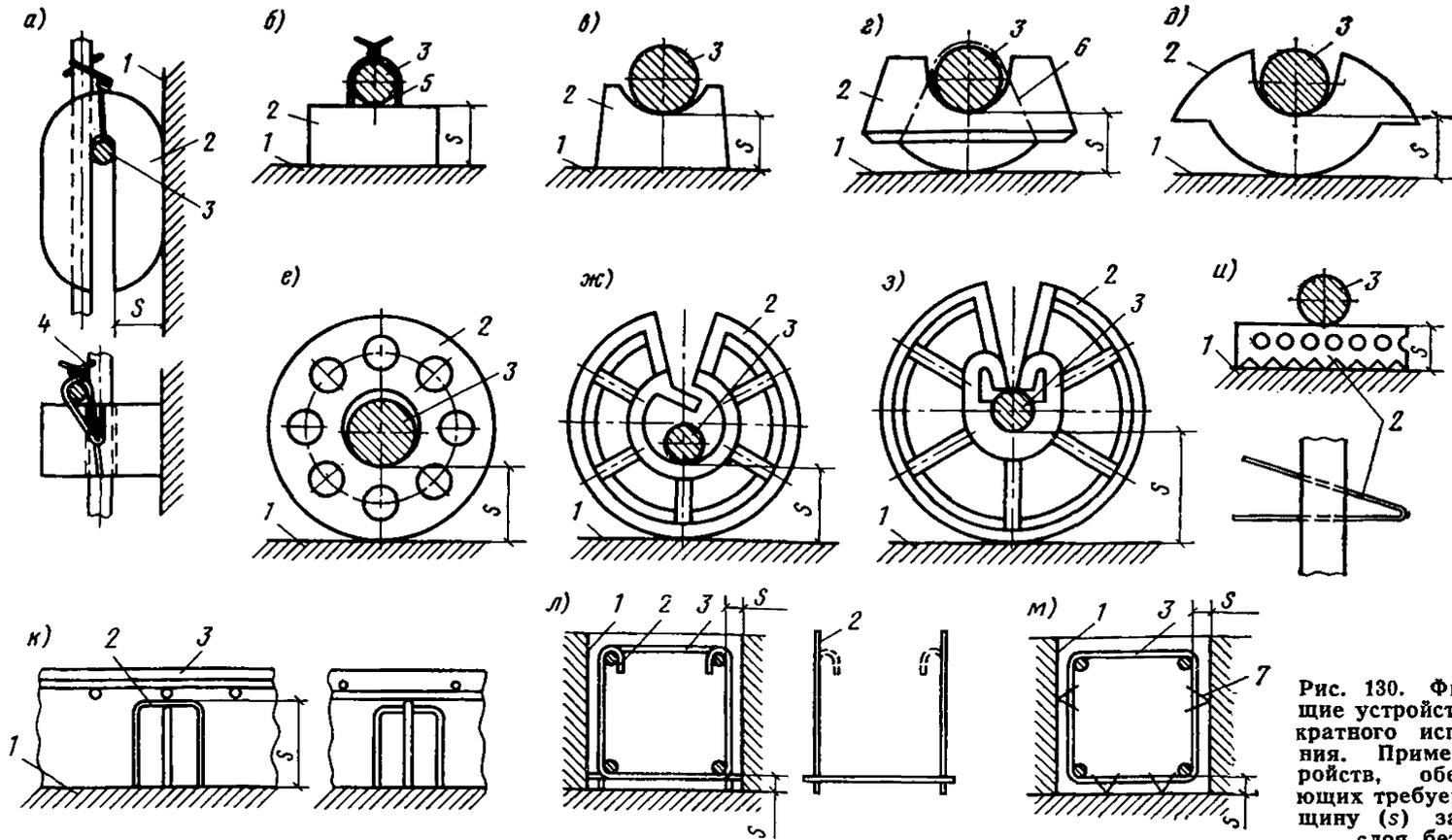
Рис. 130. Фиксирующие устройства однократного использования. Примеры устройств, обеспечивающих требуемую толщину ( $s$ ) защитного слоя бетона
