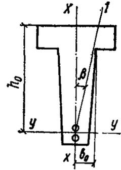
Рис. 7. Сечение с растянутыми арматурными стержнями в плоскости оси *x*
