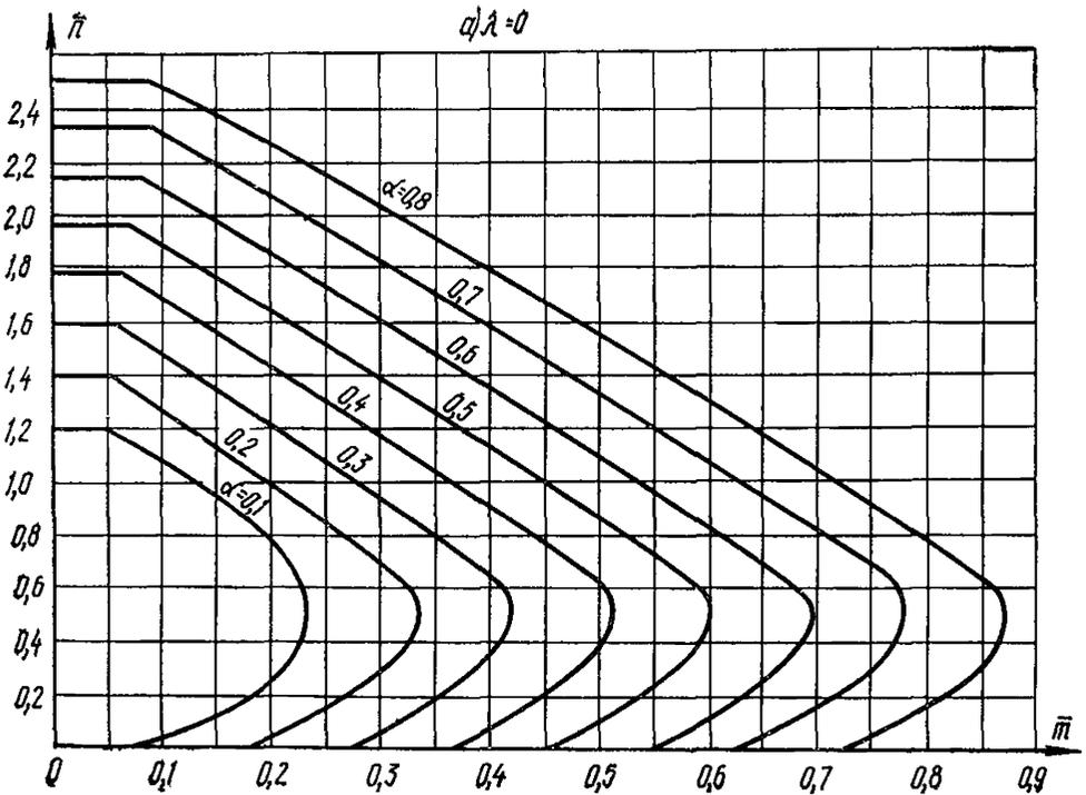
Рис. 29. Графики несущей способности внецентренно-сжатых элементов прямоугольного сечения с симметричной арматурой
