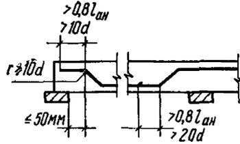
Рис. 114. Конструкция отгибов арматуры
