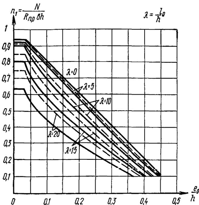
Рис. 3. График несущей способности внецентренно-сжатых бетонных элементов (сплошная линия — при  $M_1^{Дл}/M_1=1$ , пунктирная — при  $M_1^{Дл}/M_1=0,5$ )
