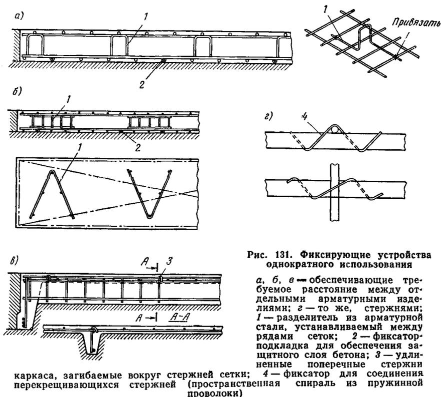
**Рис. 131.** Фиксирующие устройства однократного использования
