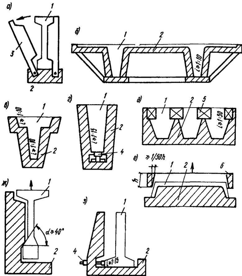
Рис. 88. Технологические уклоны
