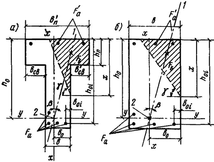
Рис. 6. Форма сжатой зоны в поперечном сечении железобетонного элемента, работающего на косоу изгиб
