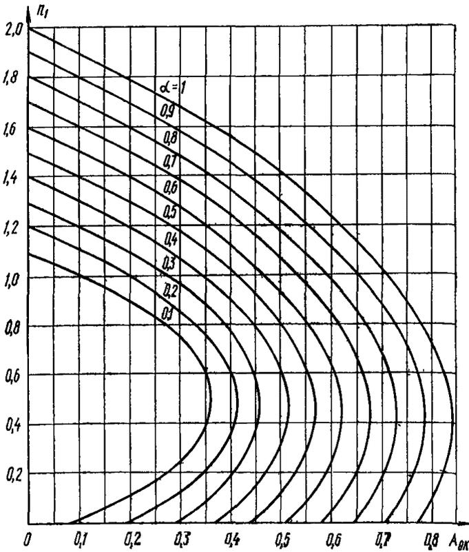
Рис. 33. Графики несущей способности внецентренно-сжатых элементов кольцевого сечения
