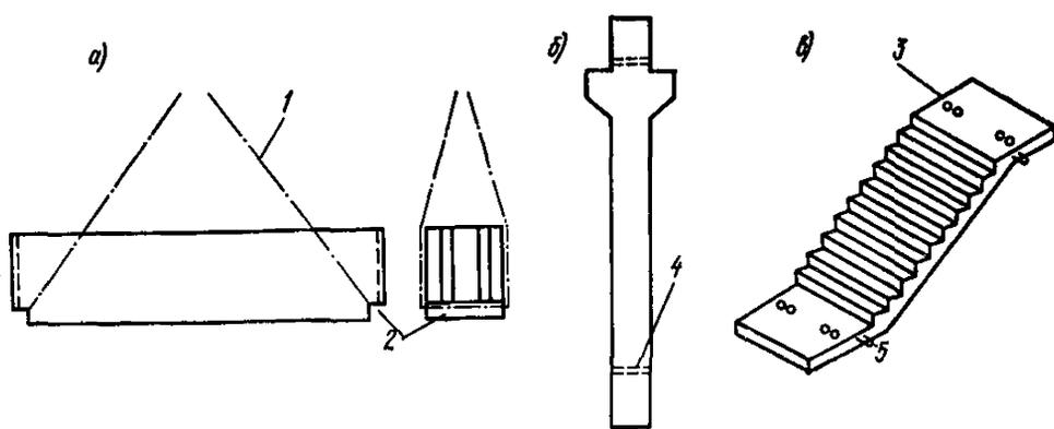
Рис. 122. Примеры строповочных устройств без петель
