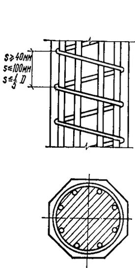
Рис. 119. Спиральное косвенное армирование железобетонных элементов
