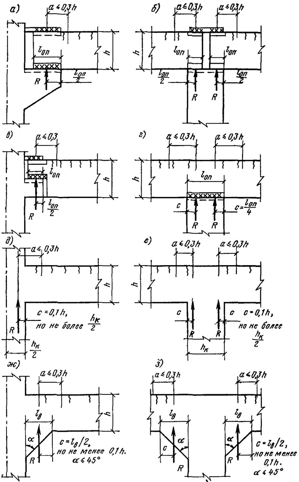
Рис. 80. Положение опорных реакций в жестких узлах, принимаемое для определения коэффициента  $K_M$
