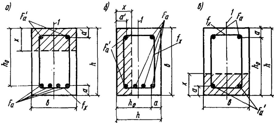
Рис. 46. Расчетные схемы расположения сжатой зоны пространственного сечения
