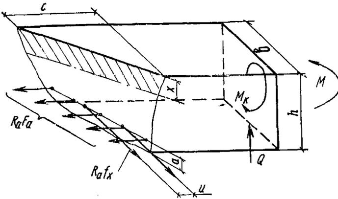
Рис. 45. Схема усилий в пространственном сечении железобетонного элемента
