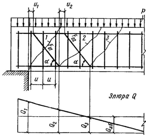
Рис. 14. Места расположения невыгоднейших наклонных сечений при расчете по поперечной силе для элементов с отогнутыми стержнями 1, 2 и 3 — невыгоднейшие наклонные сечения
