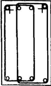
Рис. 113. Конструкция хомутов вязаных каркасов балок
