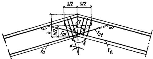
Рис. 61. Армирование входящего угла, расположенного в растянутой зоне железобетонного элемента
