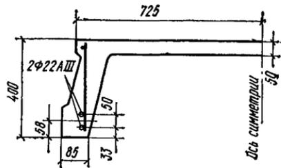
Рис. 83. Сборная железобетонная плита перекрытия
