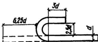
Рис. 89. Размеры крюков на концах стержней рабочей арматуры
