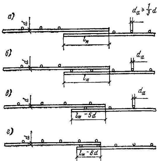
Рис. 107. Стыки внахлестку (без сварки) сварных сеток в направлении рабочей арматуры периодического профиля
