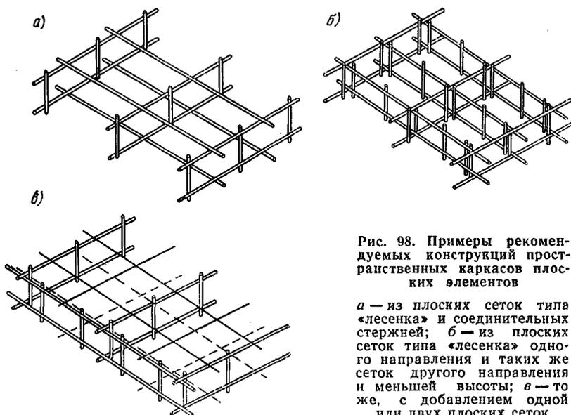
Рис. 98. Примеры рекомендуемых конструкций пространственных каркасов плоских элементов
