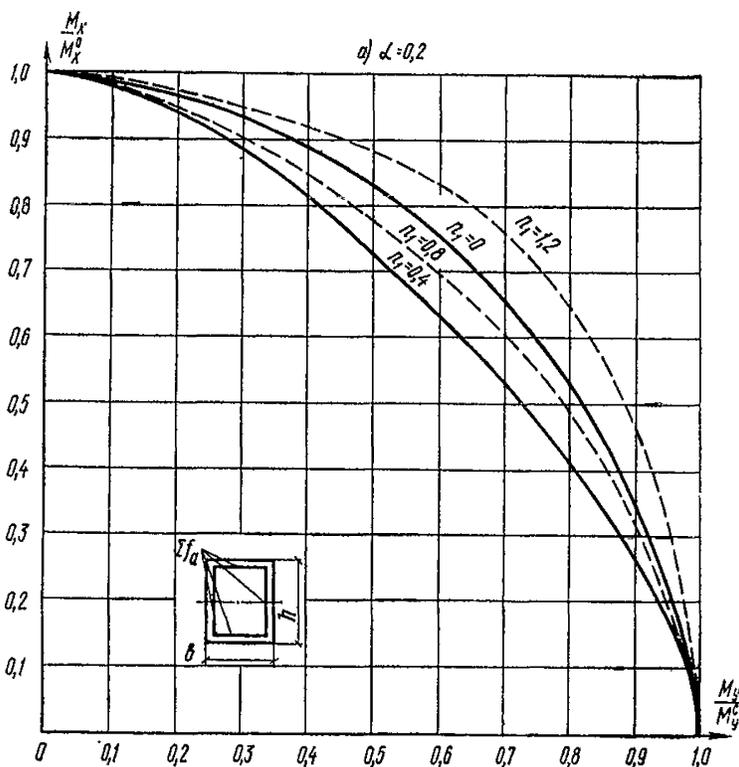
Рис. 36. Графики несущей способности элементов прямоугольного сечения с симметричной арматурой, работающих на косое внецентренное сжатие
