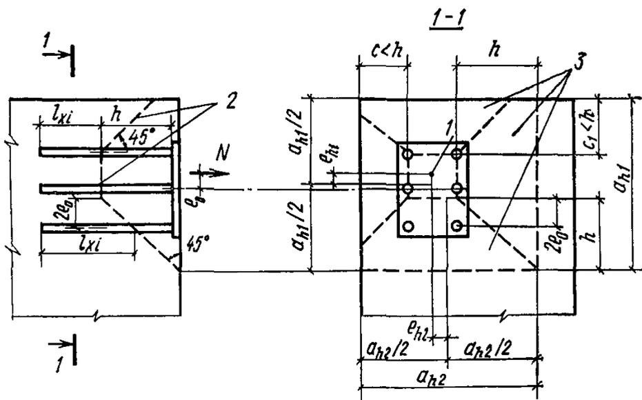
Рис. 69. Схема выкалывания бетона анкерами закладной детали без усиления на концах при  $N_{ан} < 0$
