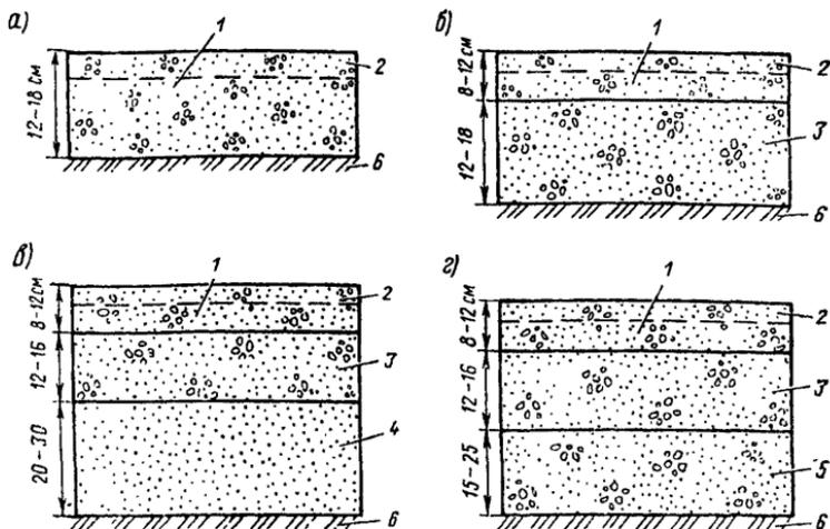
**Рис. 1.2. Примеры конструкций дорожных одежд с гравийными покрытиями**
