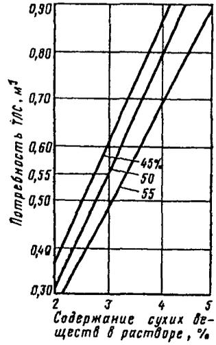
**Рис. 2.** Номограмма для определения количества ЛСТ при приготовлении 1 м³ раствора (цифры на прямых обозначают содержание сухих веществ в ЛСТ)
