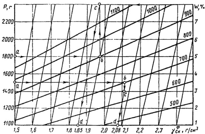
**Рис. 2.** Номограмма для определения плотности гравийного покрытия (цифры на наклонных прямых обозначают объем измеренной лунки)
