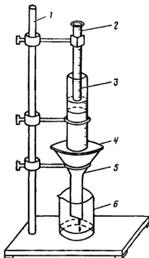
**Рис. 1.** Прибор для определения водостойкости лигносульфонатов технических
