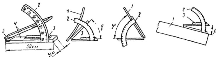
Рис. 3.1. Угломер и его установка при замере углов захвата  $\varphi$ , резанья  $\gamma$  и наклона  $\beta$ :
