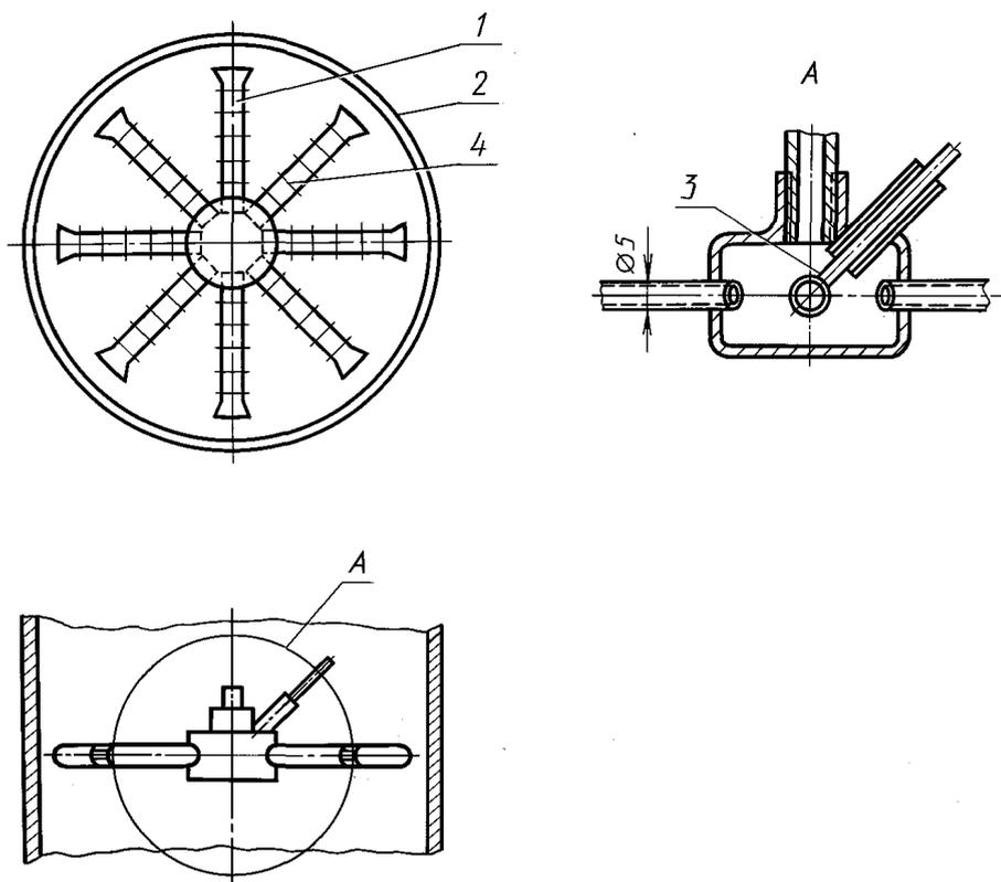
1 — устройство для отбора проб; 2 — канал отвода продуктов сгорания; 3 — термометр;
