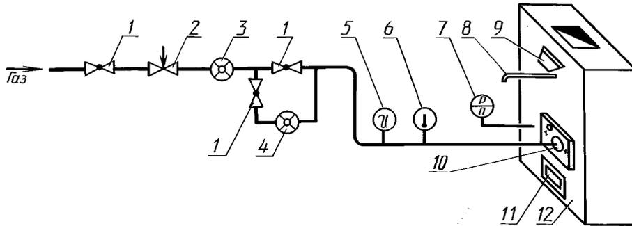
1 — кран пробковый проходной; 2 — вентиль регулирующий; 3 — счетчик газовый ГКФ-6; 4 — счетчик газовый ГСБ-400; 5 — мановакуумметр; 6 — термометр; 7 — тягонапормер; 8 — пробоотборник; 9 — шибер; 10 — устройство горелочное; 11 — регулятор вторичного воздуха; 12 — печь отопительная газовая бытовая
