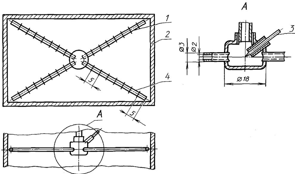
1 — устройство для отбора проб; 2 — канал отвода продуктов сгорания;
