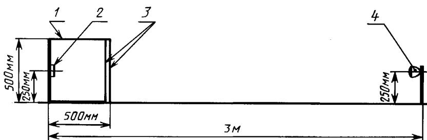
1 — темный ящик; 2 — извещатель; 3 — два стеклянных полотна толщиной 4 мм на расстоянии 10 мм;
