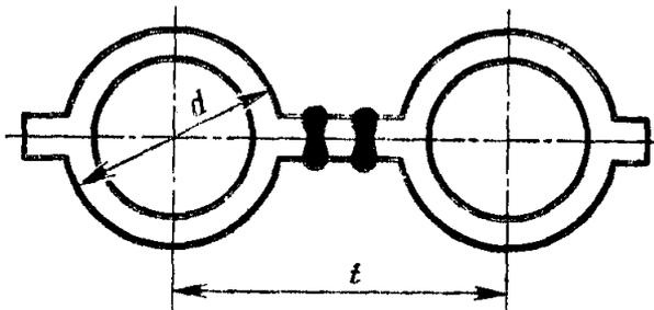
$d$ —наружный диаметр трубы;  $t$ —расстояние между осями труб
