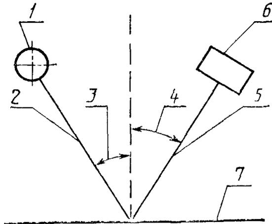
1 — источник света; 2 — ось светового пучка, падающего на образец; 3 — угол падения; 4 — угол отражения; 5 — ось светового пучка, отраженного от образца; 6 — фотоприемник; 7 — плоскость измерений
