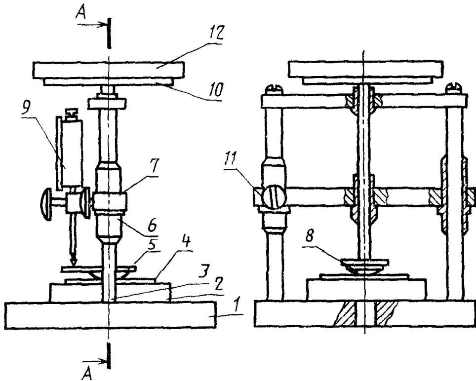
1 — основание; 2 — столик; 3 — шток; 4 — образец; 5 — опорная пластина;
