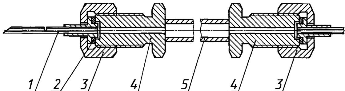
1 — игла; 2 — прокладка алюминиевая; 3 — накидная гайка; 4 — штуцер; 5 — корпус патрона-концентратора
