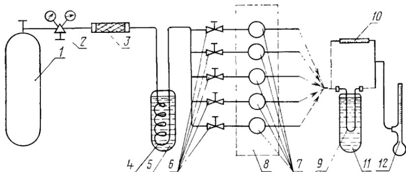
1—баллон со сжатым азотом; 2—редуктор; 3—ловушка с цеолитом; 4—ловушка металлическая; 5—сосуд Дьюара с охлаждающей смесью; 6—игльчатый вентиль; 7—сосуды; 8—термостат; 9—петля-концентратор; 10—патрон-концентратор; 11—сосуд Дьюара; 12—пенный расходомер
