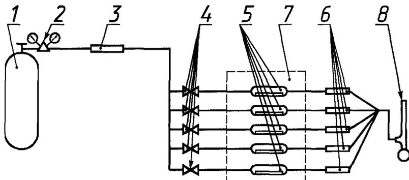
1 — баллон со сжатым газом; 2 — редуктор; 3 — ловушка с цеолитом;
