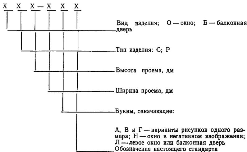
В конце марки окон и балконных дверей с одинарным остеклением, перед обозначением стандарта, добавляется цифра 1 через тире.
