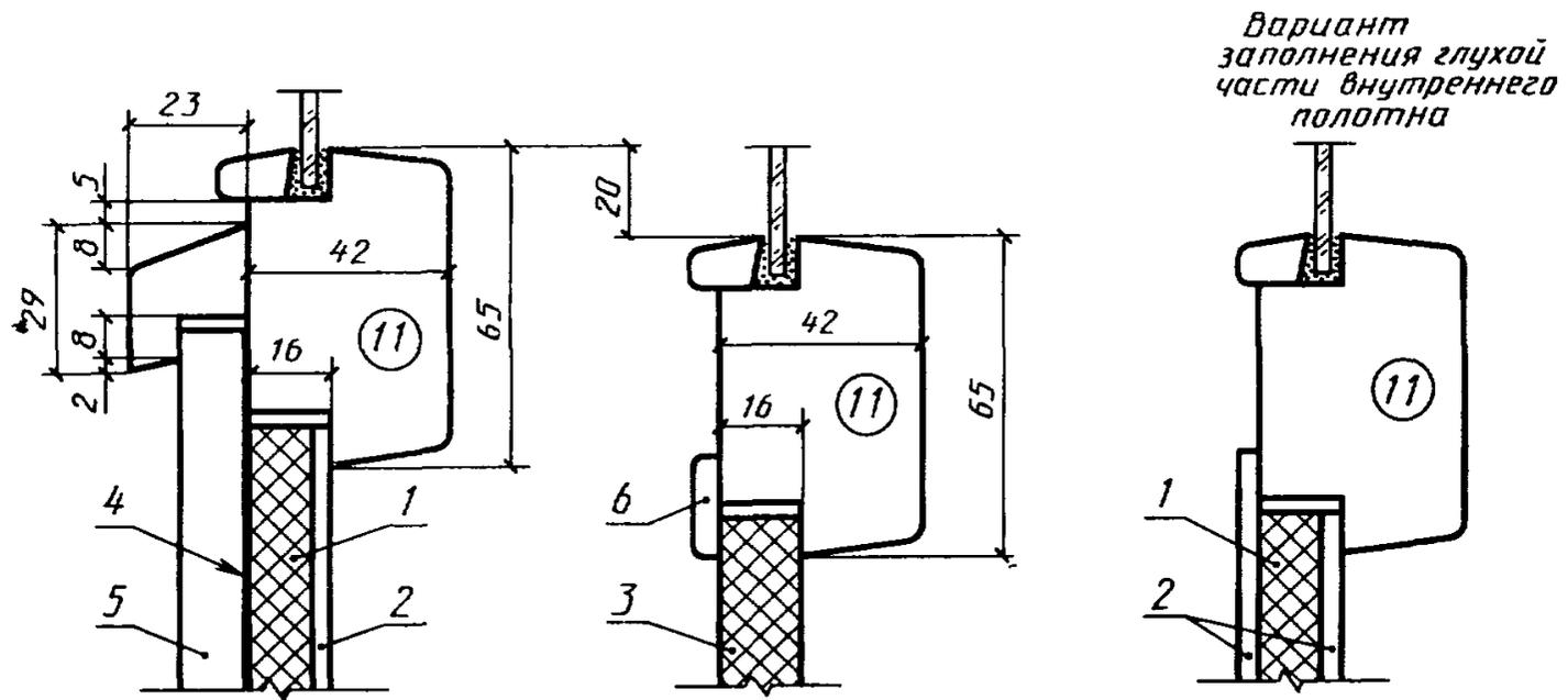
1 — мягкая древесноволокнистая плита толщиной 12 мм по ГОСТ 4598—86; 2 — твердая древесноволокнистая плита марок СТ, ТВ, Т группы «А» толщиной 3,2—4 мм по ГОСТ 4598—86; 3 — шлифованная древесностружечная плита толщиной 16 мм по ГОСТ 10632—89; 4 — пергамин по ГОСТ 2697—83; 5 — обшивка марки О-3 по ГОСТ 8242—88; 6 — раскладка.
