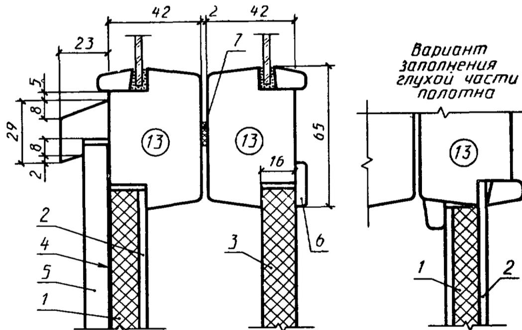
1 — мягкая древесноволокнистая плита толщиной 12 мм по ГОСТ 4598—86; 2 — твердая древесноволокнистая плита марок СТ, ТВ, Т группы «А» толщиной 3,2—4 мм по ГОСТ 4598—86; 3 — шлифованная древесностружечная плита толщиной 16 мм по ГОСТ 10632—89; 4 — пергамин по ГОСТ 2697—83; 5 — обшивка марки О-3 по ГОСТ 8242—88; 6 — раскладка; 7 — уплотняющая прокладка.
