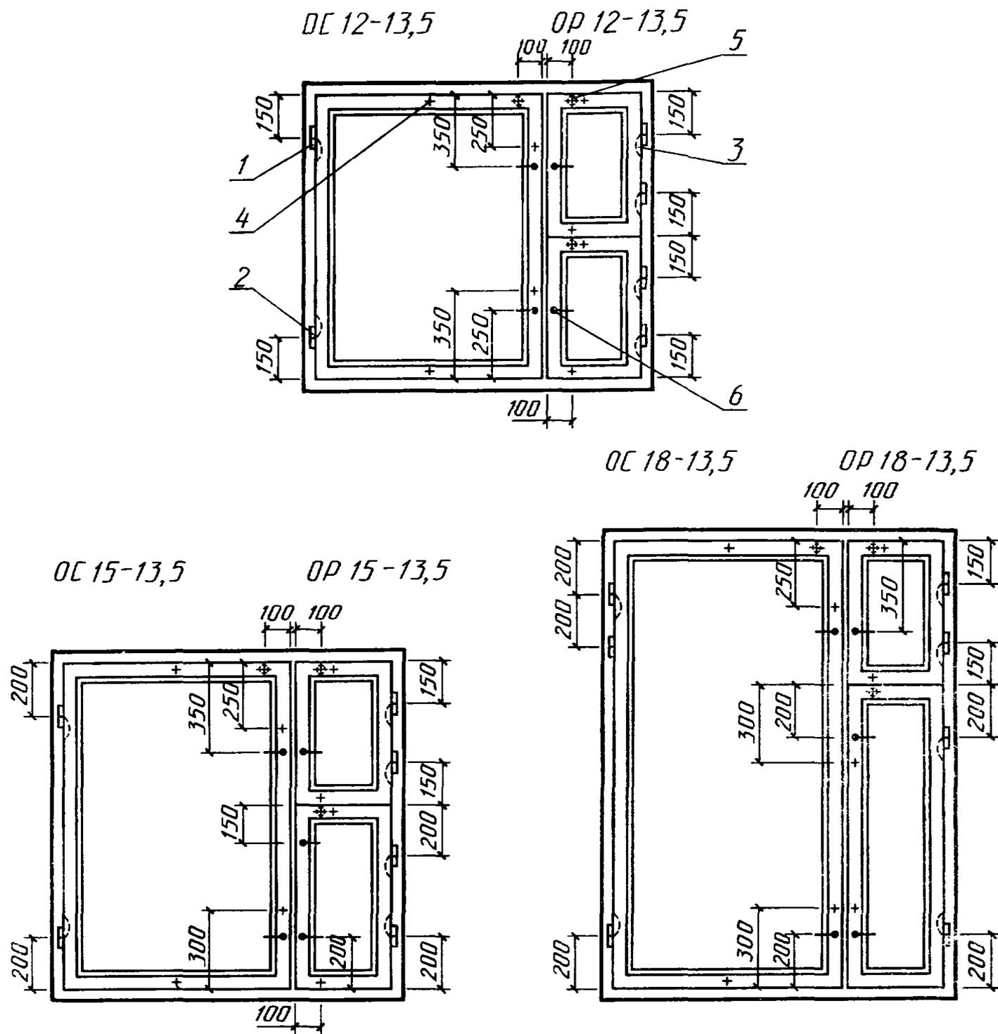
1 — петля ПВ1—100 для внутренних створок и полотен типов С и Р; 2 — петля ПВ2—100—1 для наружных створок и полотен типа Р; 3 — петля ПВ3—1 для типа С; 4 — стяжка СТ для типа С; 5 — упор УО для типа Р; 6 — заvertка ЗР2—1,
