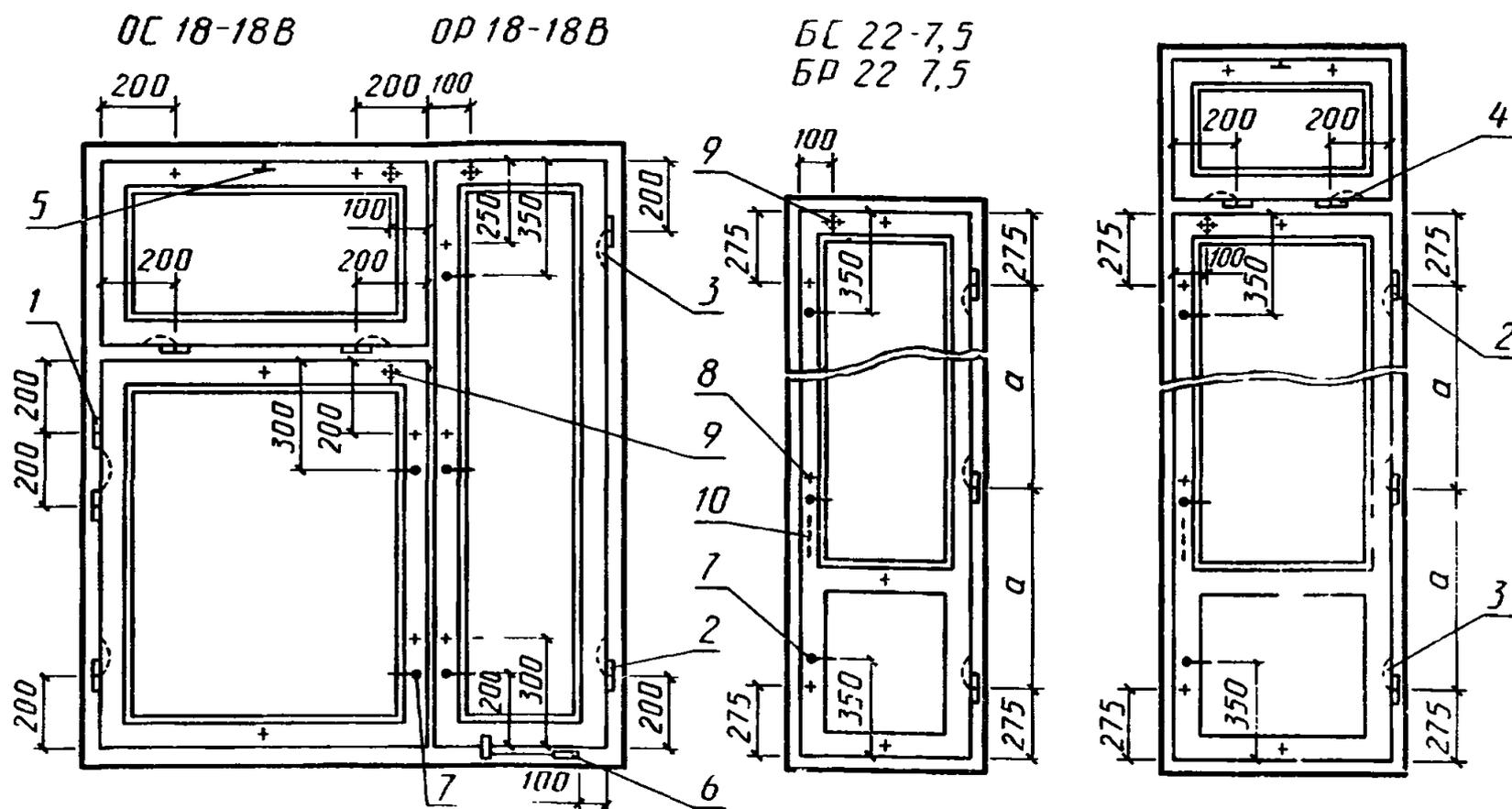
1 — петля ПВ1—100 для внутренних створок и полотен типов С и Р; 2 — петля ПВ2—100—1 для наружных створок и полотен типа Р; 3 — петля ПВ3—1 для типа С; 4 — петля ПВ2—100—2 для фрагуг; 5 — прибор фрамужный ПФ2; 6 — фиксатор ФК1 для типа С или ФК3 для типа Р; 7 — завертка ЗРЯ—1; 8 — стяжка СТ для типа С; 9 — упор УО для типа Р; 10 — ручка РС80.
