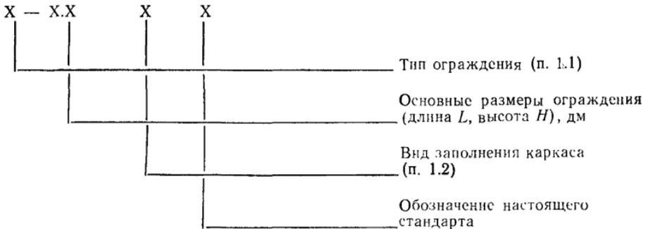
Пример условного обозначения марки ограждения лестничного марша внутренней лестницы длиной 2700 и высотой 900 мм, решетчатого:
