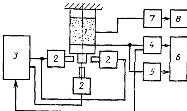
1—образец; 2—электромагниты; 3—блок формирования одиночного импульса; 4—блок измерения модулей  $E$  и  $G$ ; 5—блок измерения логарифмического декремента затухания; 6—блок отображения информации с дисплеем; 7—блок измерения температуры с дисплеем; 8—блок электронного регулирования температуры.
