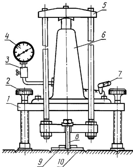
1 — основание (плита); 2 — регулировочные винты (опорные пяты); 3 — защитный клапан; 4 — манометр; 5 — контурная (или силовая) рамка; 6 — гидродомкрат усилием 20 кН (2 тс); 7 — насос; 8 — стержень захвата; 9 — приклеиваемая стальная плитка; 10 — керамическая плитка
