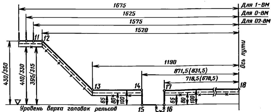
б) Для подвижного состава, проходящего по путям железных дорог Союза ССР колеи 1520 (1524) мм и путям железных дорог — членов ОСЖД колеи 1435 мм, включая пути сортировочных горок железных дорог Союза ССР, оборудованные вагонными замедлителями, при нерабочем (отторможенном) их положении.
