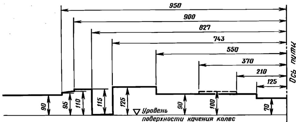
б) Очертание, за пределы которого не должна выступать ни одна из частей вагонного замедлителя при его нерабочем (отторможенном) положении.
