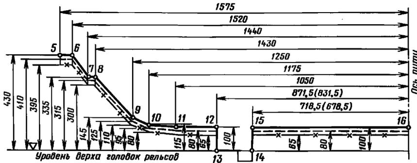
б) Для подвижного состава, проходящего по путям железных дорог Союза ССР колеи 1520 (1524) мм, а также европейских и азиатских железных дорог колеи 1435 мм, включая пути сортировочных горок, оборудованных вагонными замедлителями при любом их положении.
