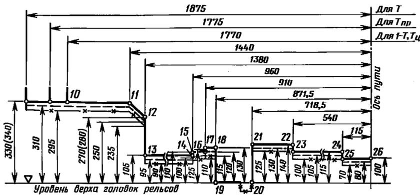
г) Для подвижного состава, проходящего по всем путям железных дорог Союза ССР колеи 1520 (1524) мм, включая пути сортировочных горок, оборудованные вагонными замедлителями при любом их положении, и пути, оборудованные устройством для надвига вагонов (см. черт. 6).
