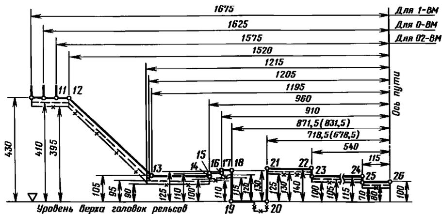
г) Для подвижного состава, проходящего по путям железных дорог Союза ССР колеи 1520 (1524) мм и путям железных дорог — членов ОСЖД колеи 1435 мм, включая пути сортировочных горок, оборудованные на дорогах — членах ОСЖД колеи 1435 мм вагонными замедлителями нового типа (построенными по габариту, рекомендованному ОСЖД на перспективу), при любом их положении.
