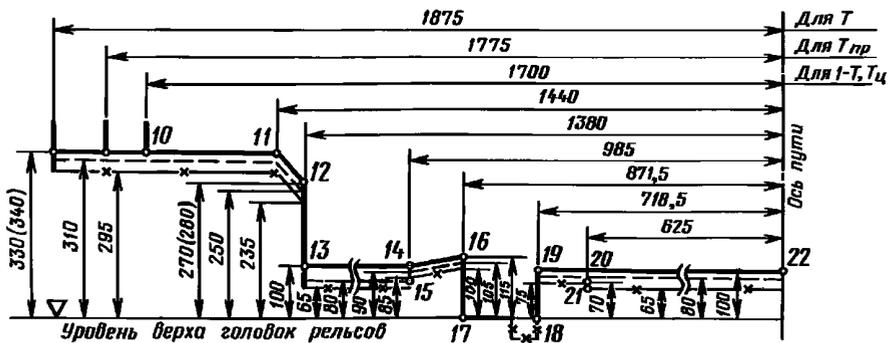
в) Для подвижного состава, проходящего по всем путям железных дорог Союза ССР колеи 1520 (1524) мм, включая пути сортировочных горок, оборудованные вагонными замедлителями при любом их положении.
