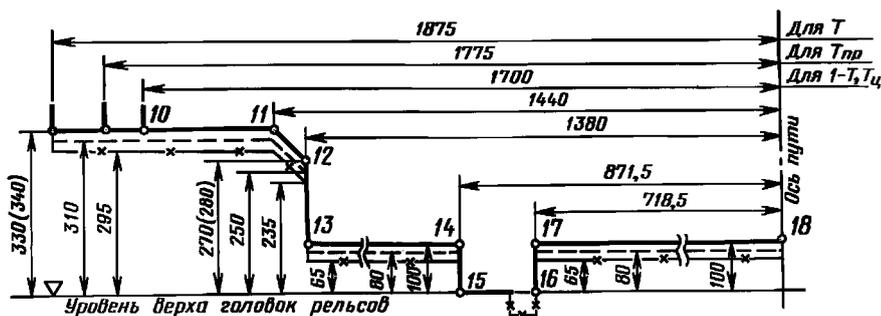
б) Для подвижного состава, проходящего по всем путям железных дорог Союза ССР колеи 1520 (1524) мм, включая пути сортировочных горок, оборудованные вагонными замедлителями при нерабочем (отторможенном) их положении.
