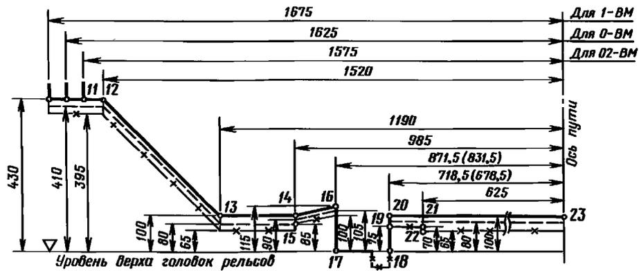
в) Для подвижного состава, проходящего по путям железных дорог Союза ССР колеи 1520 (1524) мм и путям железных дорог — членов ОСЖД колеи 1435 мм, включая пути сортировочных горок железных дорог Союза ССР, оборудованные вагонными замедлителями, при любом их положении.
