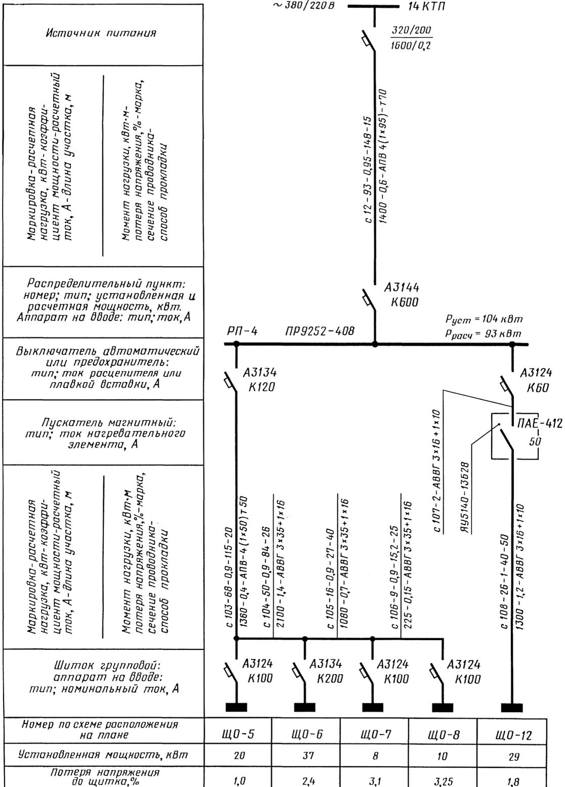
Пример оформления принципиальной схемы питающей сети многоэтажного здания
