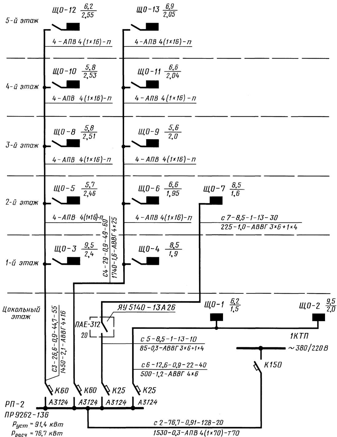
**Поясняющие надписи на принципиальной схеме питающей сети, выполняемой с учетом расположения электрического оборудования по частям и этажам здания**
