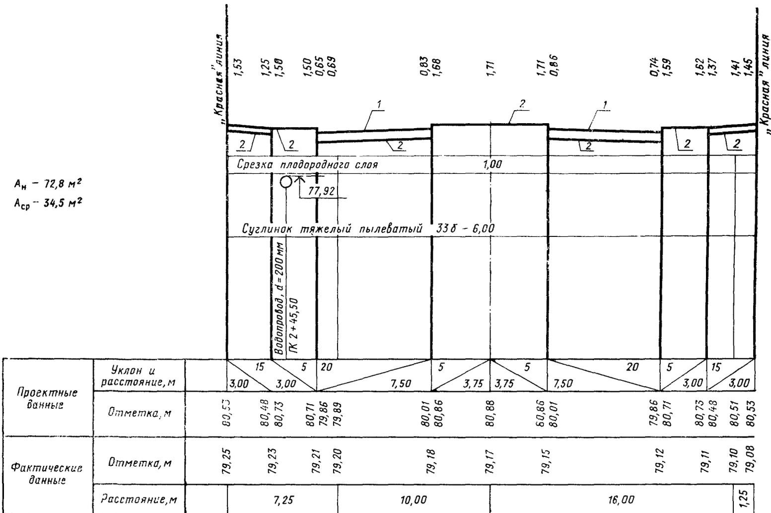
1— линия верха проезжей части; 2— линия верха земляного полотна
