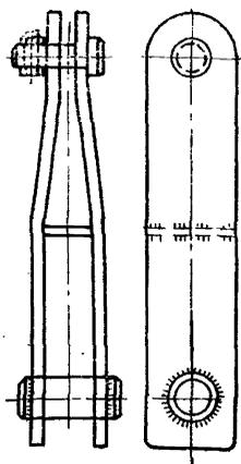
Рис. 25. Серьги для подъема тяжелых грузов
