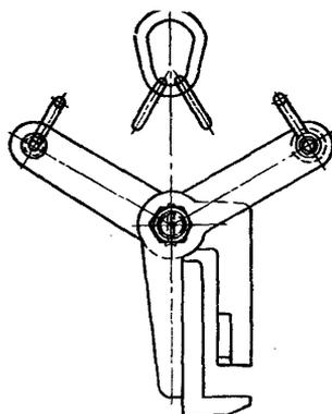
Схема струбцины уголка
