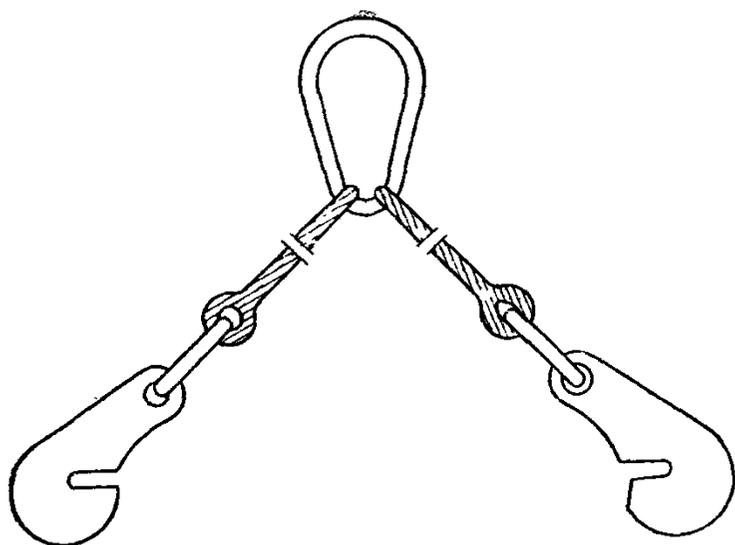
Рис. 18. Захват для листового металла типа
