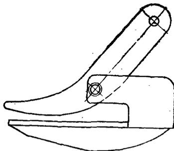
Рис. 15. Захват для швеллера и двутавра
