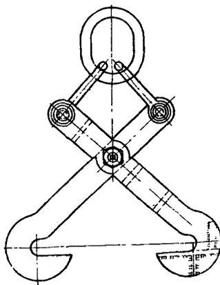
Рис. 28. Захват для балок и колонн
