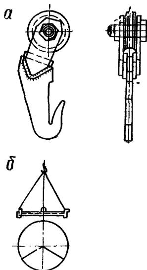
Рис. 26. Тросовый захват для транспортировки днищ и резервуаров: а — крюк захвата; б — схема строповки днища захватом
