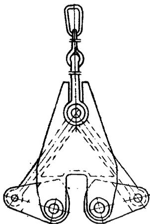
Рис. 14. Захват для листового металла типа НТ 205-00
