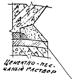
СХЕМА СОПРЯЖЕНИЯ РИГЕЛЕЙ С КОЛОННАМИ С ВАМОНОЛИНОВАНИЕМ УЗЛОВ БЕТОНОМ. СЕРИИ МН20/70 И 1.420-12
