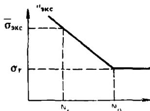
отказов сварных подкрановых балок (рисунок),  $\sigma_r = 450 \text{ кгс/см}^2$  — предельное напряжение сварных подкрановых балок, характеризующие неограниченную долговечность балок;  $m = 761,39$  — параметр кривой усталостных отказов сварных подкрановых балок;  $\bar{\sigma}_{\text{экс}}$  — среднестатистическое напряжение в верхней зоне стенки от эксплуатационной крановой нагрузки.
