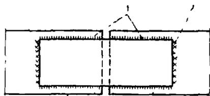
Рис. 23. Усиление сварного соединения доваркой лобовых швов
