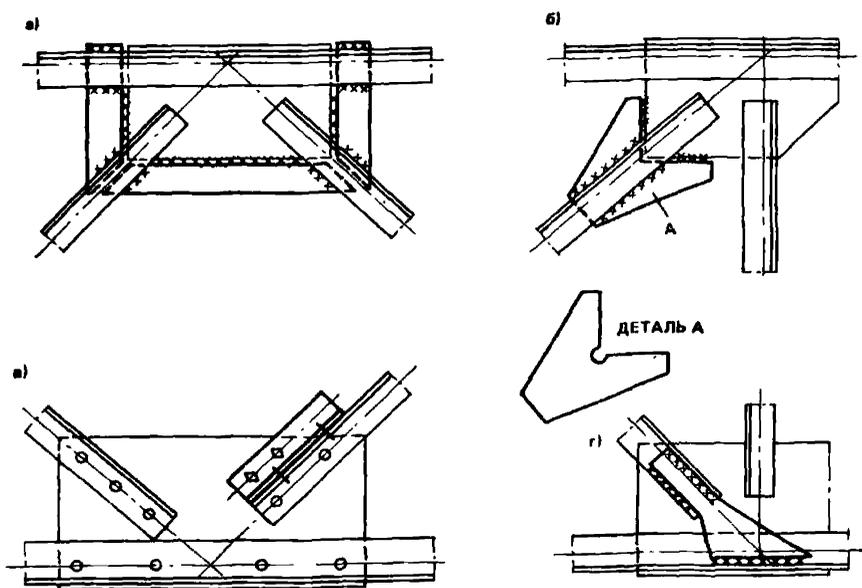
Рис. 8. Усиление узлов крепления стержней стропильных ферм
