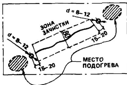
Рис. 28. Подготовка трещины к заварке
