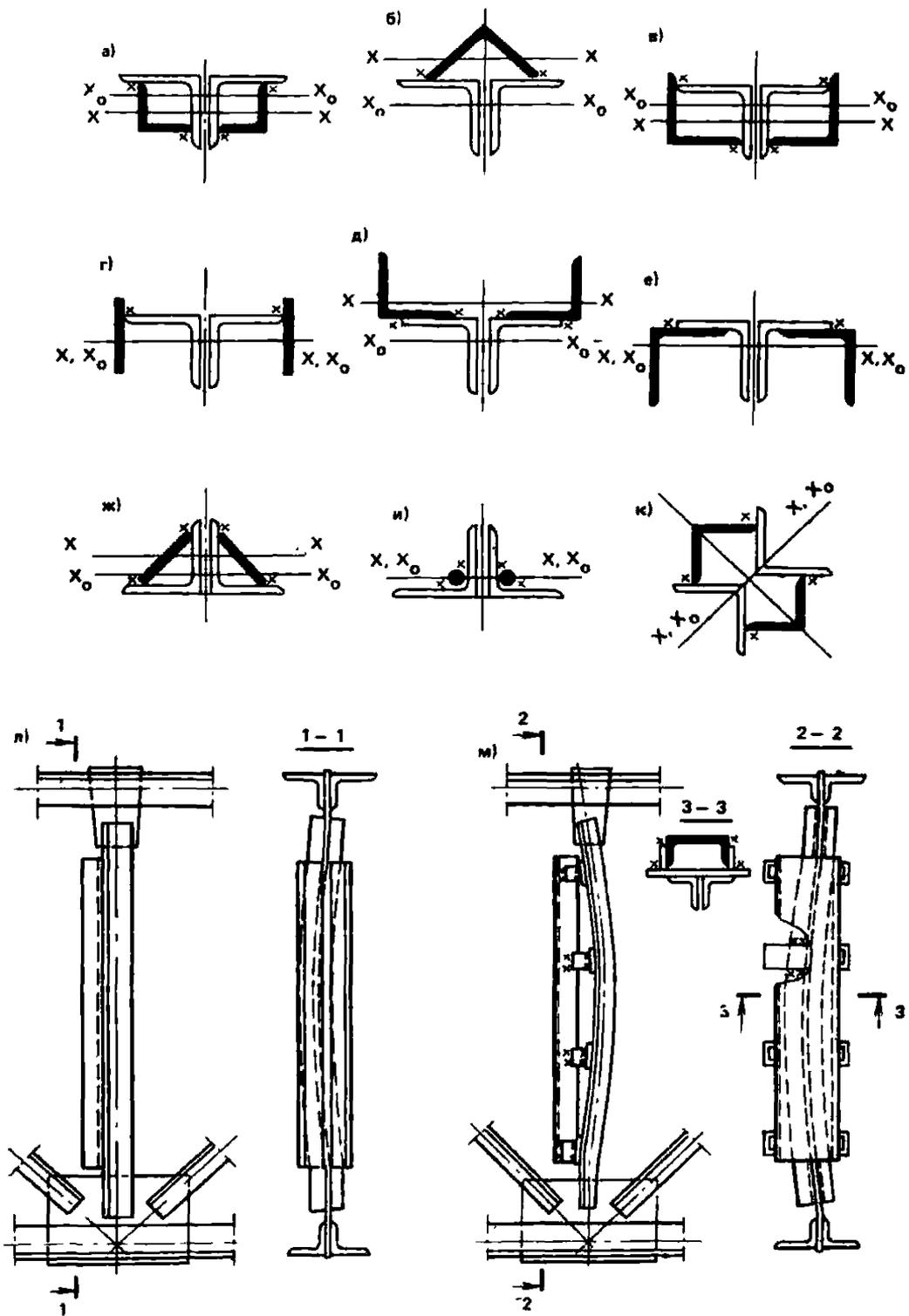
Рис. 7. Усиление элементов стропильных ферм
