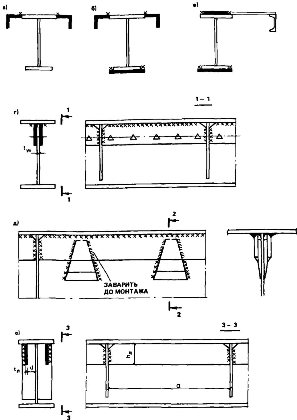
Рис. 6. Усиление подкрановых балок
