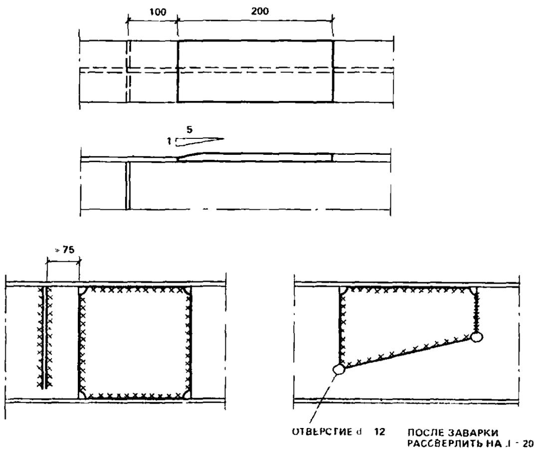
Рис. 25. Конструктивные требования к взаимному расположению швов
