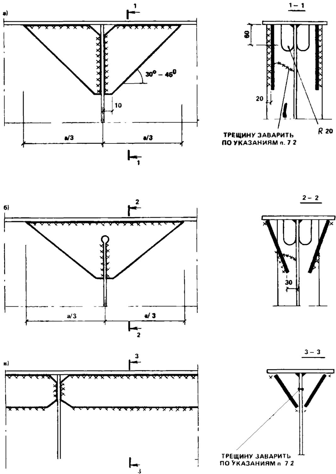
Рис. 30. Усиление верхней зоны подкрановых балок
