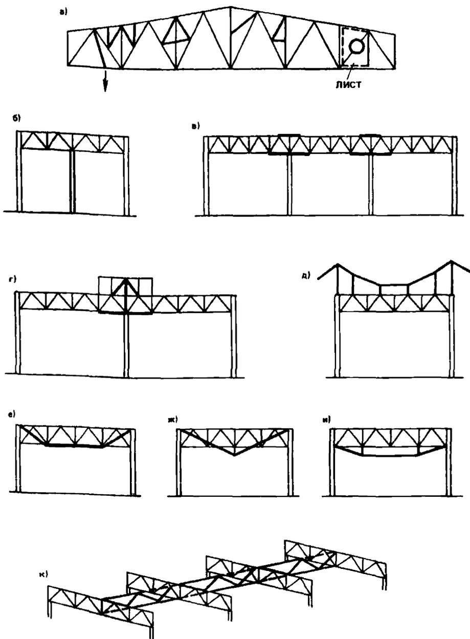
Рис. 9. Усиление стропильных ферм путем изменения их конструктивной схемы
