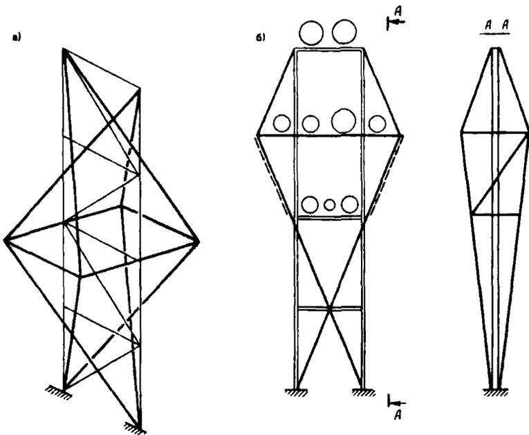
Рис. 14. Усиление плоских опор транспортерных галерей и трубопровода путем уменьшения свободной длины поясов с помощью шпренгельных систем
