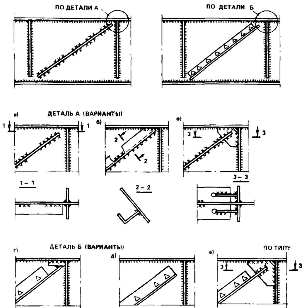
**Рис. 5. Установка наклонных ребер жесткости**
