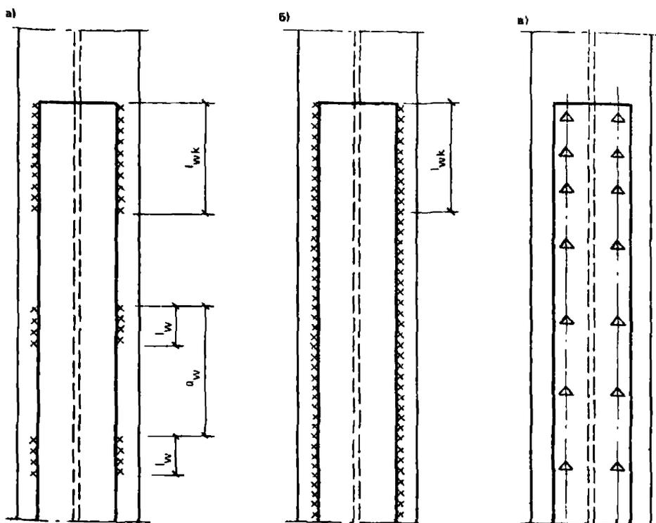
Рис. 16. Присоединение элементов усиления
