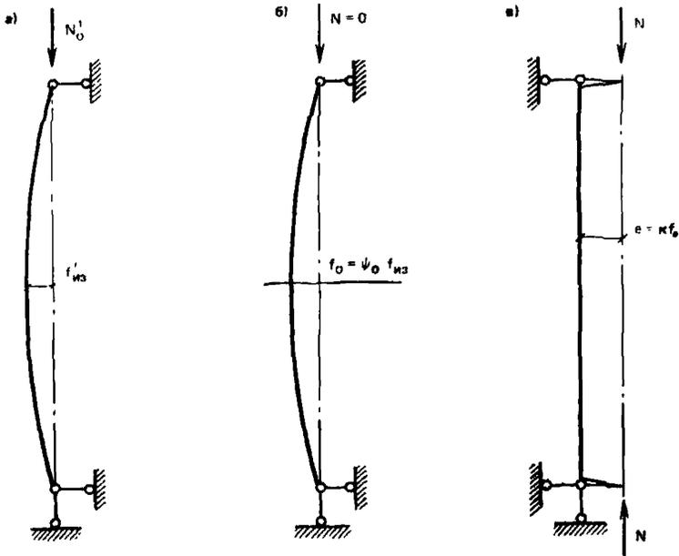
Рис. 1. Сжатый стержень с общим искривлением
