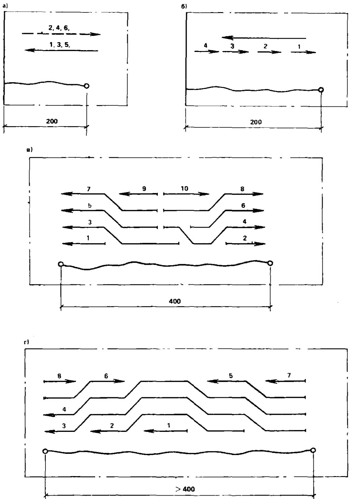
**Рис. 29. Последовательность заварки трещины**
