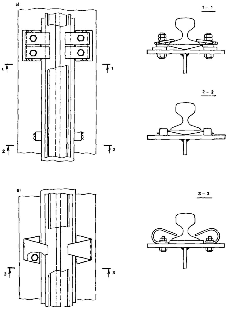
**Рис. 21. Крепление подкранового рельса**
