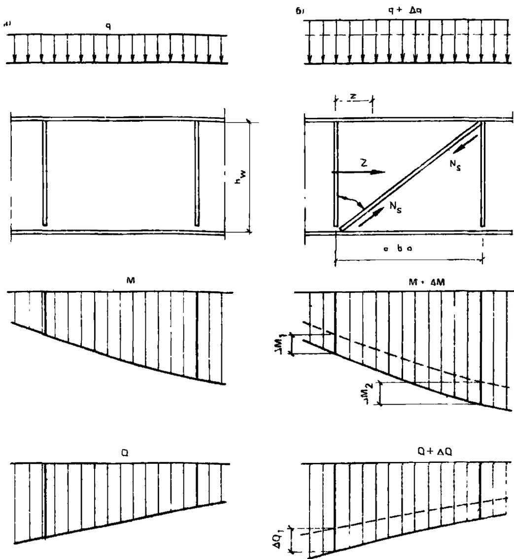
Рис. 20. К расчету наклонных ребер
