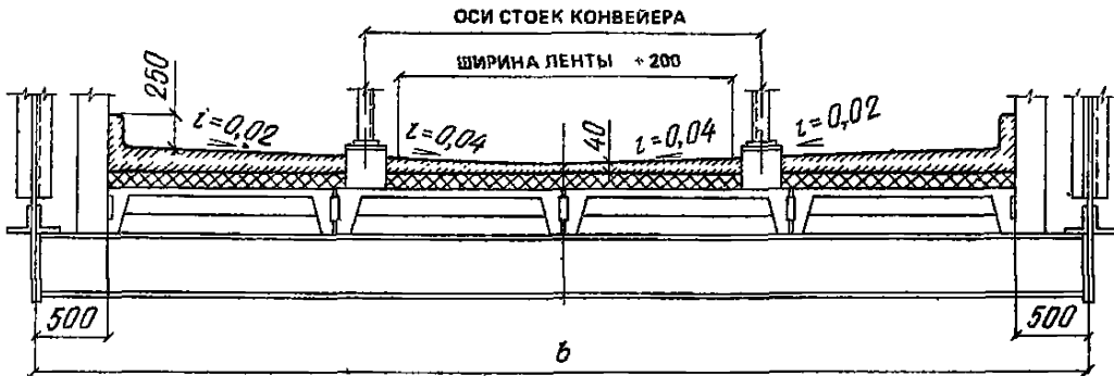
Рис. 45. Поперечное сечение перекрытия с металлическим настилом
