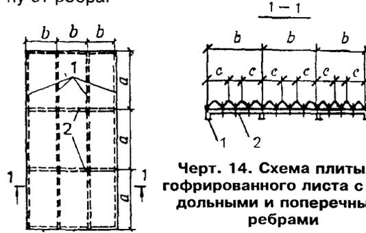
Черт. 14. Схема плиты из гофрированного листа с продольными и поперечными ребрами
