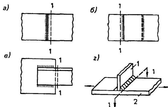
**Черт. 1.** Схемы сварных соединений конструкций а — встык, б — внахлестку лобовыми швами, в — внахлестку фланговыми швами; г — схема прикрепления поперечного элемента к элементу, не имеющему стыка; 1 — поперечный элемент; 2 — элемент без стыка; 1-1 — расчетное сечение
