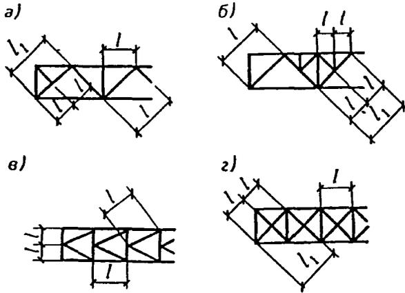
Черт. 6. Схемы решеток ферм для определения расчетной длины элементов
