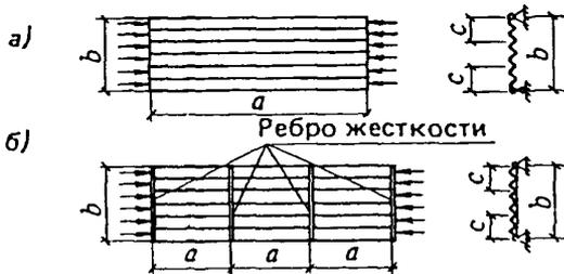
Черт. 12. Расчетная схема сжатого гофрированного листа
