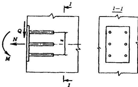
Черт. 18. Схема усилий, действующих на закладную деталь
