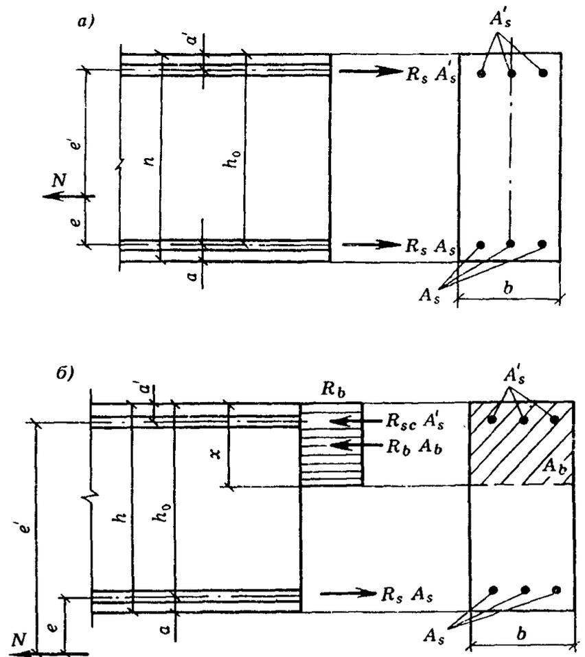
Черт. 7. Схема усилий и эпюра напряжений в сечении, нормальном к продольной оси внецентренно растянутого железобетонного элемента, при расчете его по прочности а — продольная сила  $N$  приложена между равнодействующими усилий в арматуре  $S$  и  $S'$ ; б — то же, за пределами расстояния между равнодействующими усилий в арматуре  $S$  и  $S'$
