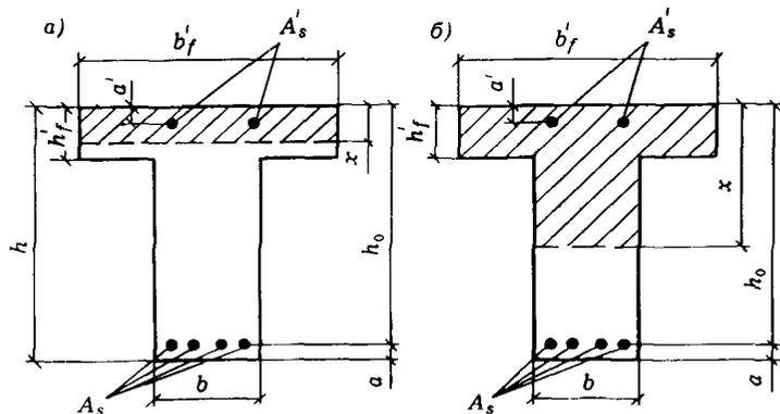
Черт. 5. Положение границы сжатой зоны в сечении изгибаемого железобетонного элемента
