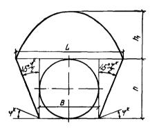
Рис. 2. Схема свода обрушения
