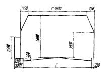
Рис. 1. Габарит приближения конструкций автодорожных тоннелей
