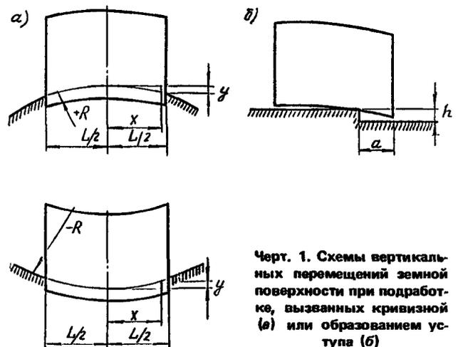
Черт. 1. Схемы вертикальных перемещений земной поверхности при подработке, вызванных кривизной (а) или образованием уступа (б)
