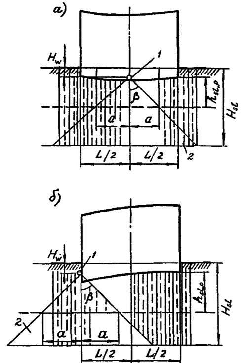
Черт. 3. Схемы вертикальных перемещений основания здания (сооружения) при просадке грунтов от внешней нагрузки
