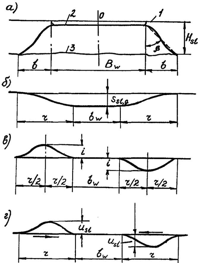
Черт. 2. Характер развития деформаций земной поверхности в пределах просадочной воронки
