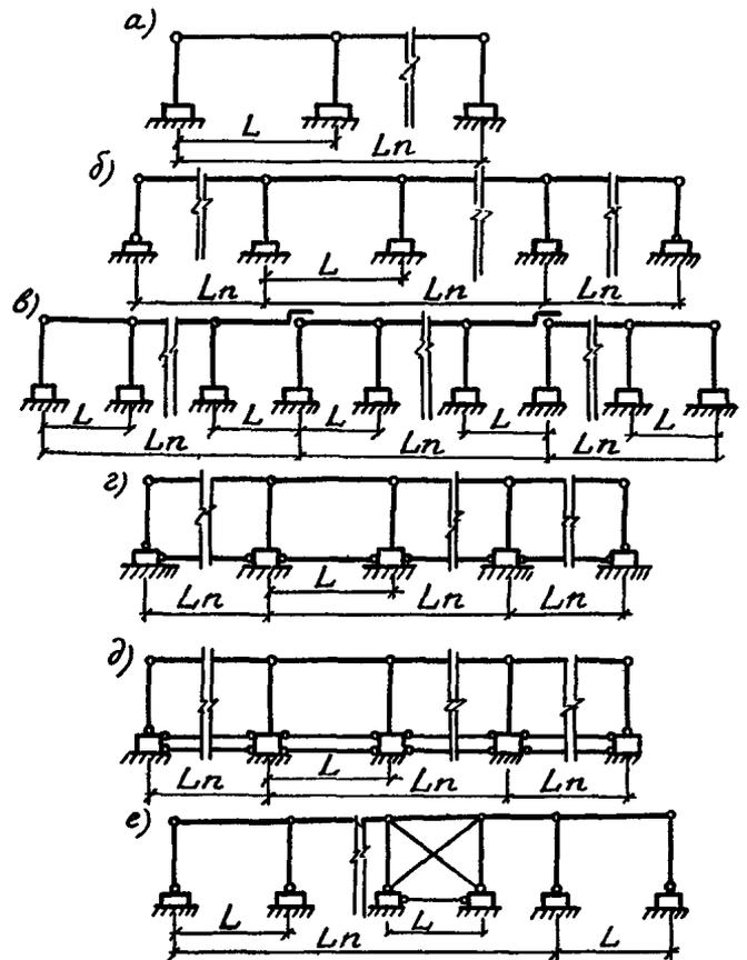
Черт. 3. Схемы поперечных рам одноэтажных каркасных зданий
