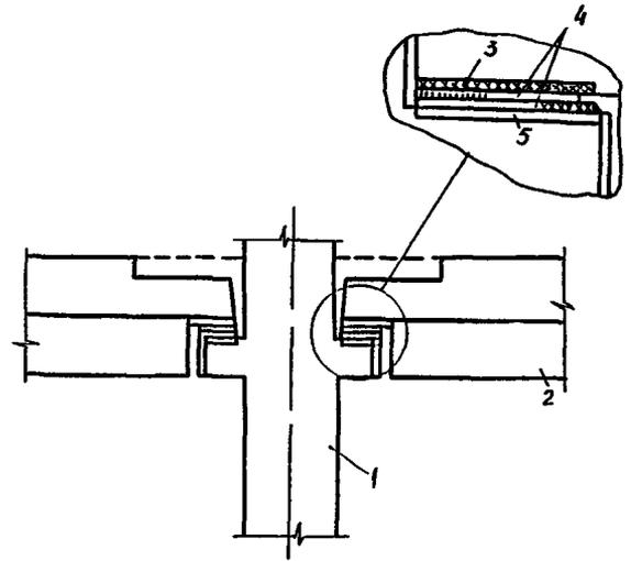
Черт. 2. Конструкция узла сопряжения ригелей с колонной
